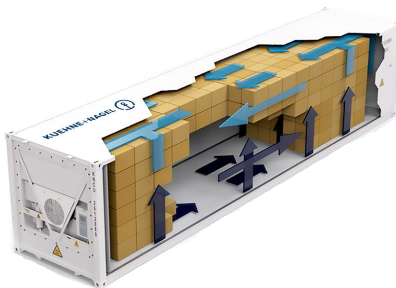
Figura 20: Flux de l'aire en contenidor refrigerat – Font: Kuehne + Nagel
