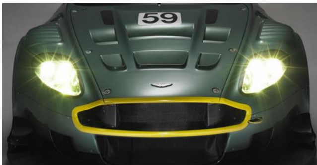
Figura 6: Entrades i sortides d'aire d'un cotxe (Font: [6])
