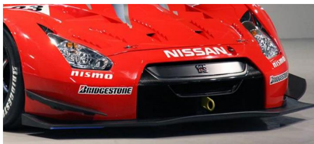
Figura 4: Splitter d'un cotxe (Font: [6])
