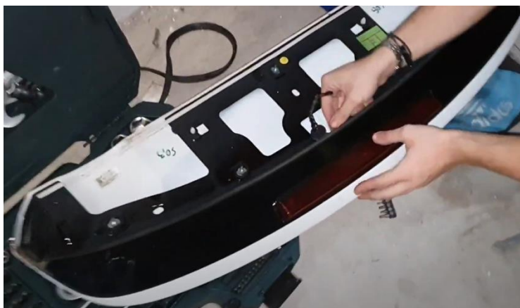
Figura 115: Peça a desmuntar per tal de muntar l'aleró (Font: [23])
