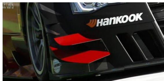
Figura 5: Aleta lateral dreta d'un cotxe (Font: [6])
