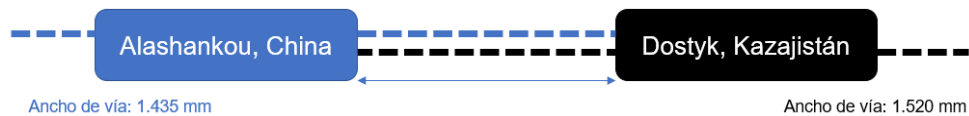
Ilustración 3: Representación del cambio de ancho de vía entre China y Kazajistán. Elaboración propia
