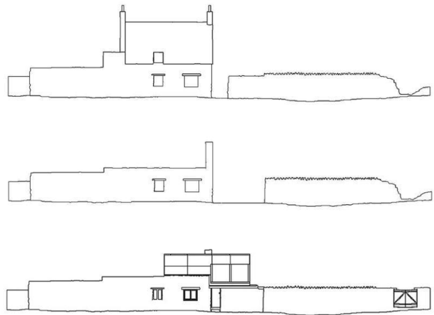
Image 09. Esquema del proceso constructivo del Upper Lawn Pavilion.
