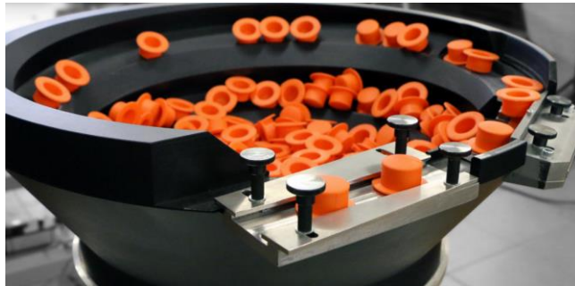
Fig. 10.29 __Ejemplo de un alimentador vibrador industrial circular [44]
