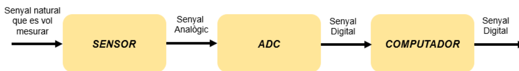
Figura 4. Font pròpia. Evolució de la naturalesa del senyal un cop tractat pels elements electrònics corresponents.
