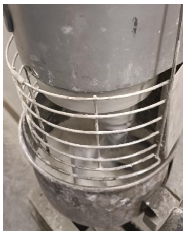
Figura 40. Máquina de reamasado con mezcla de hormigón blanco con áridos reciclados.
