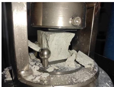
Figura 25. Probeta ensayada a compresión con equipo de ensayo utilizado.
