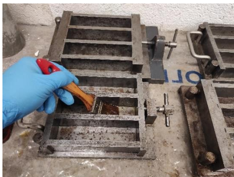
Figura 19. Aplicación de desencofrante al molde.
