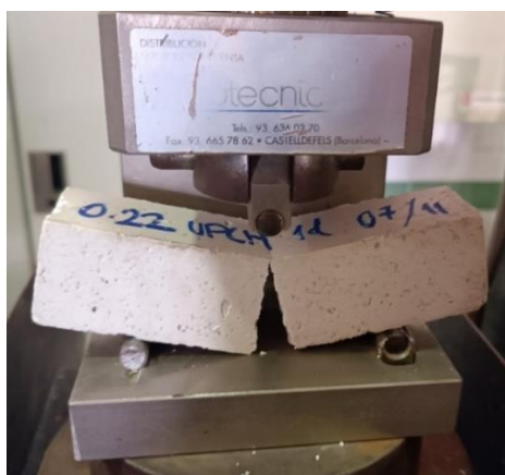
Figura 23. Probeta ensayada a flexión con equipo de ensayo utilizado (punto central de carga).
