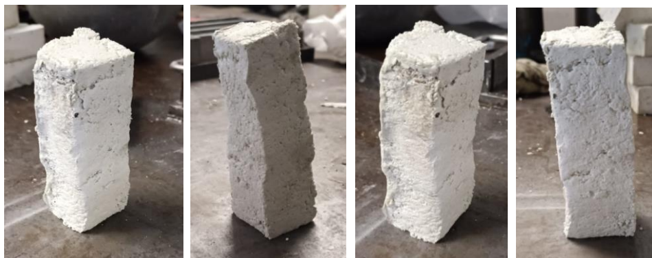
Figura 63. Soporte de propio peso de la muestra 8 en estado fresco.
