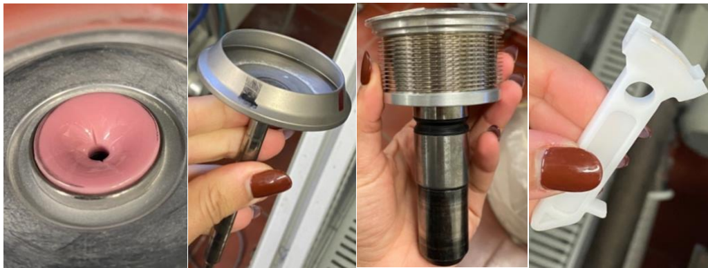
Figura 33. Òrgans de filatura utilitzats. De esquerra a dreta: boqueta, rotor, disgregador, torque stop
