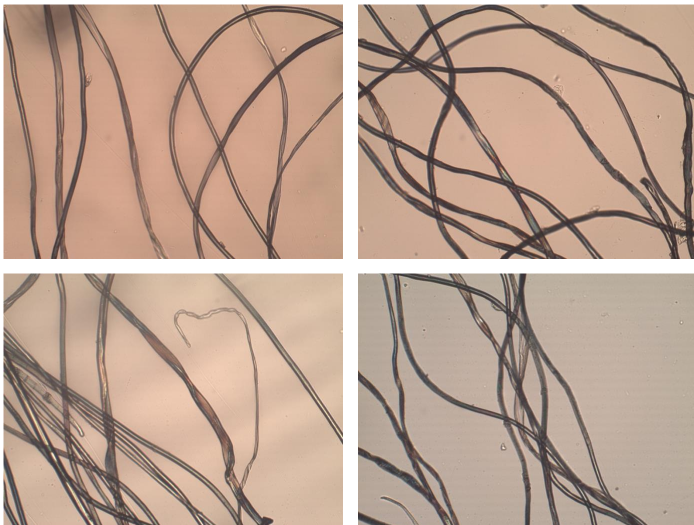
Figura 36. Composició dels fils d'ordit (esquerra) i de trama (dreta) dels teixits blau marí (superiors) i blau cel (inferiors)
