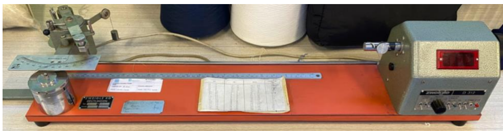
Figura 7. Torsiòmetre electrònic. ZWEIGLE KG REUTLINGEN
