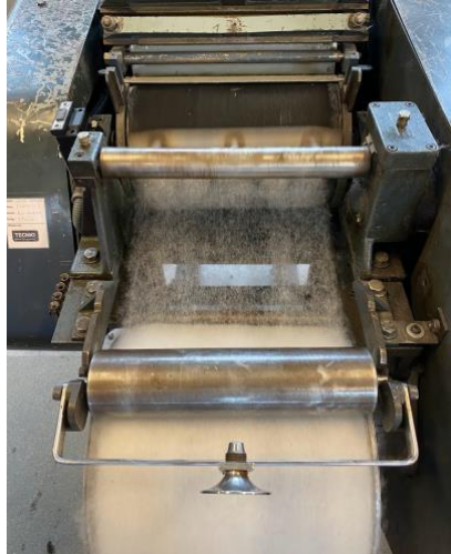
Figura 28. Minicarda processant la fibra de CO/PES verge
