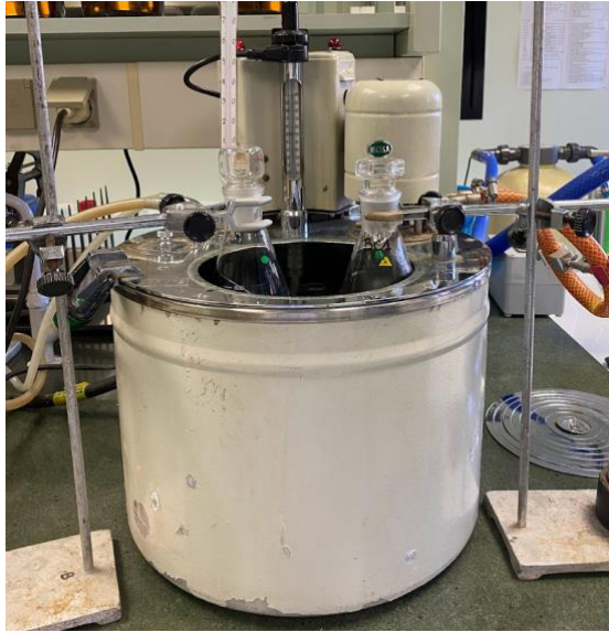
Figura 22. Bany d'aigua a 50\text{ }^{\circ}\text{C} \pm 5\text{ }^{\circ}\text{C} dels matrassos cònics
