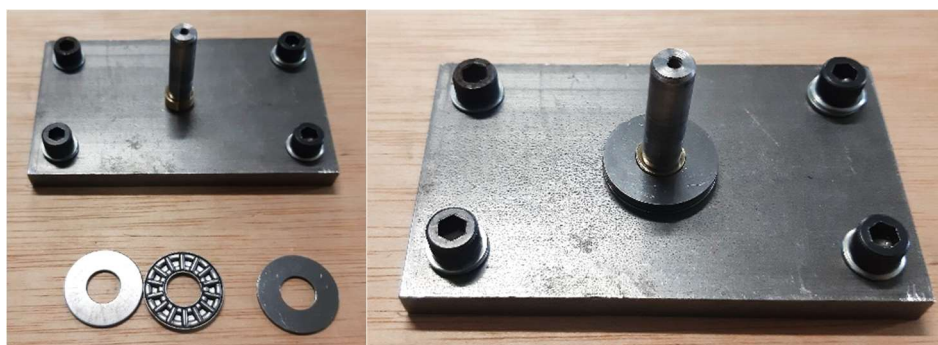
Figura 12. Muntatge rodament axial.
