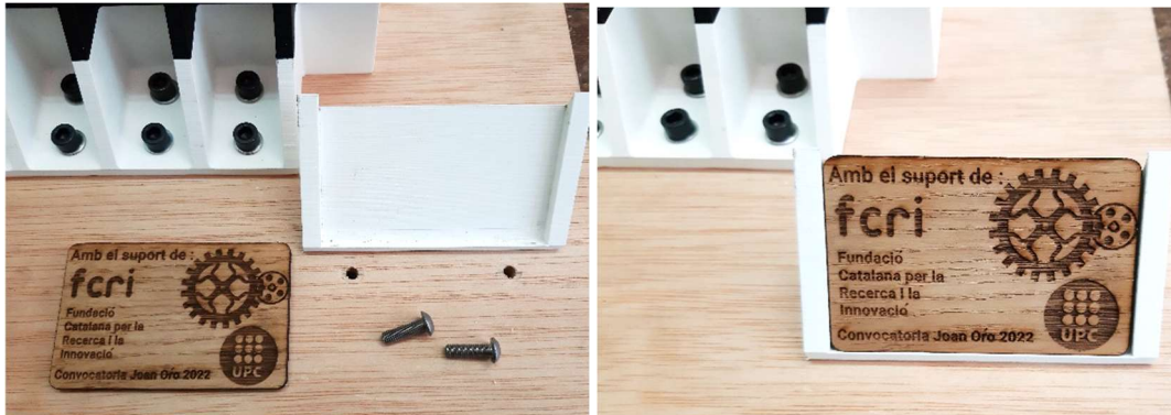
Figura 16. Muntatge suport targeta per identificar maqueta.
