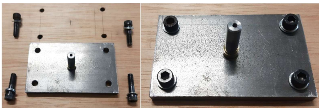
Figura 11. Unió conjunt placa metàl·lica i eix amb bancada.
