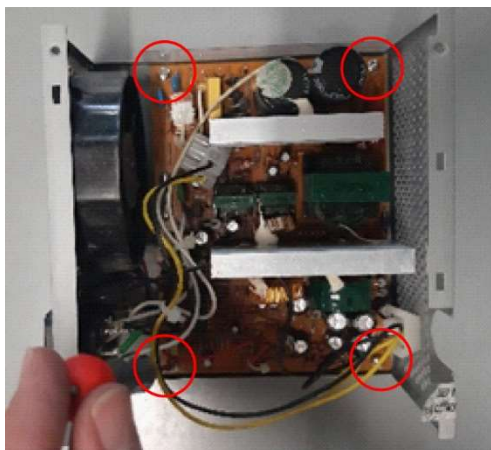
Figura 20. Descargolar la PCB de la carcassa.
