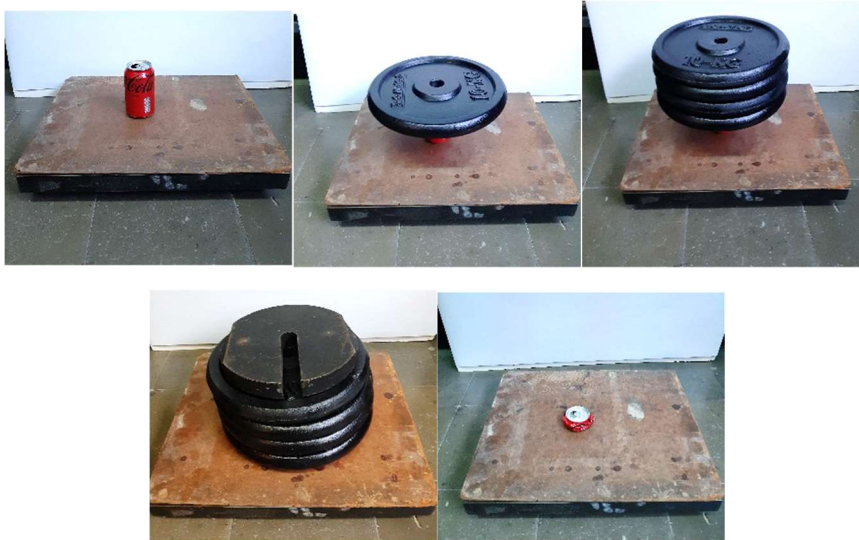
Figura 2. Assaig per determinar la força necessària per aixafar una llauna.
