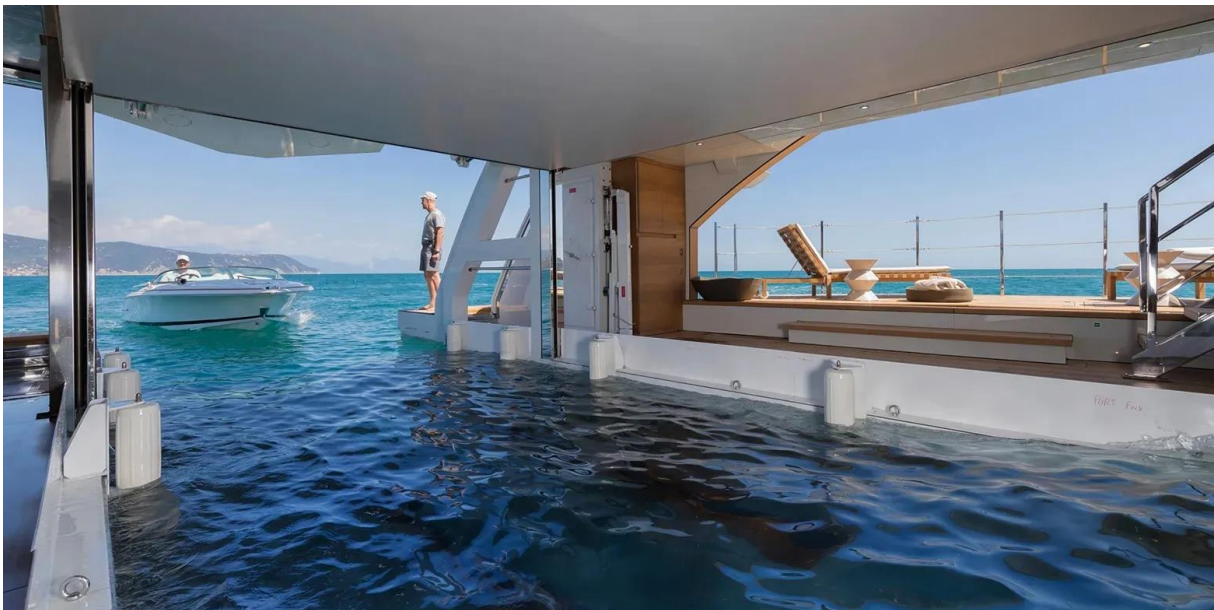
Figura 7. Vista interior del dique del MY Octopus. Fuente: Boat international.
