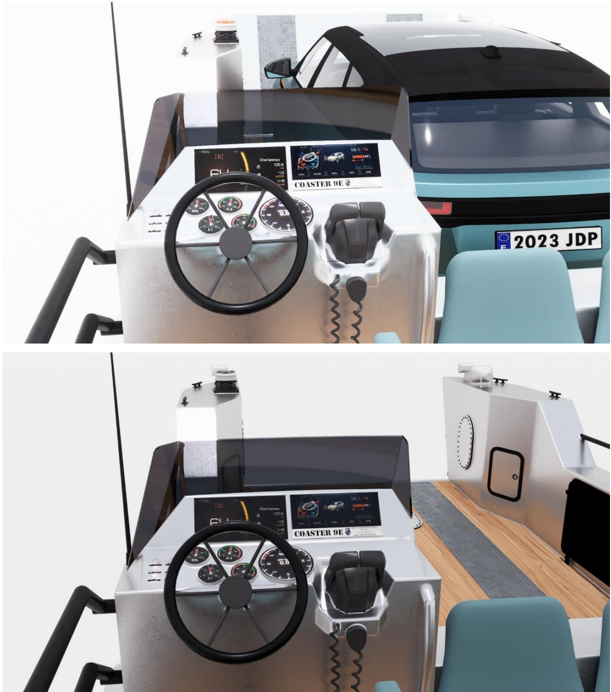
Figura 27. Vista del puesto de gobierno, con vehículo todoterreno embarcado y desembarcado.
