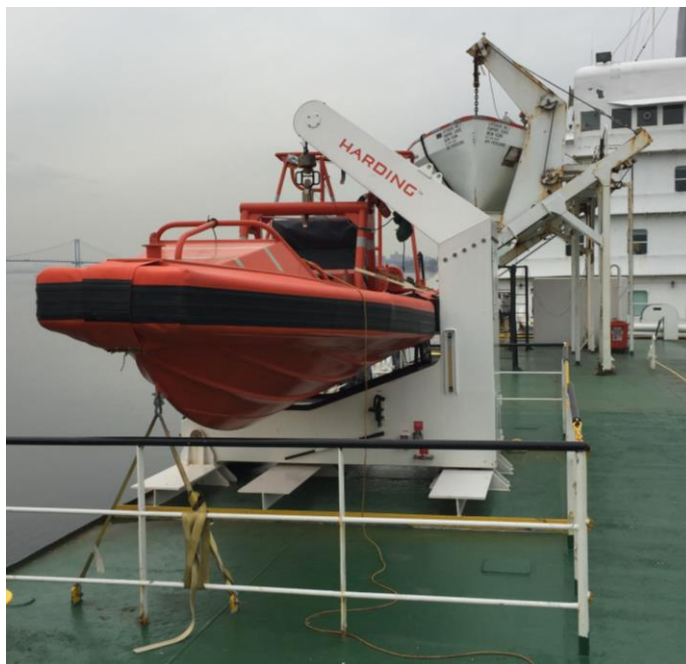
Figura 8. Embarcación de rescate estibada en cubierta. Fuente: SUNY Maritime College.
