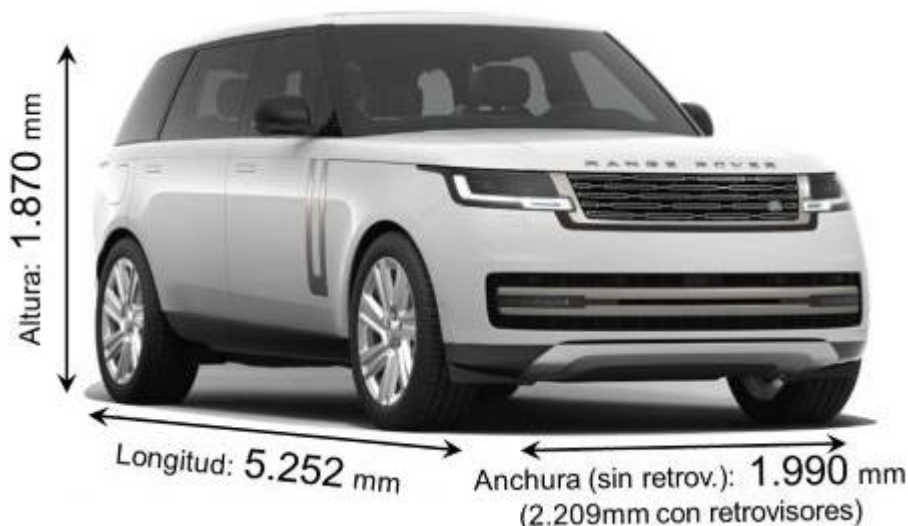
Figura A5. Dimensiones Range Rover LWB. Fuente: Medidas de coches.
