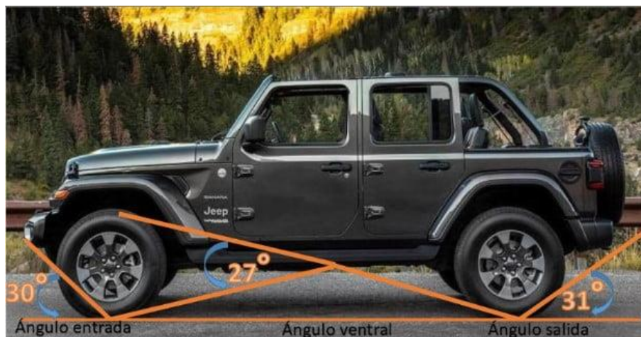
Figura 13. Ángulos relevantes en vehículos off-road . Fuente: Pruebaderuta.
