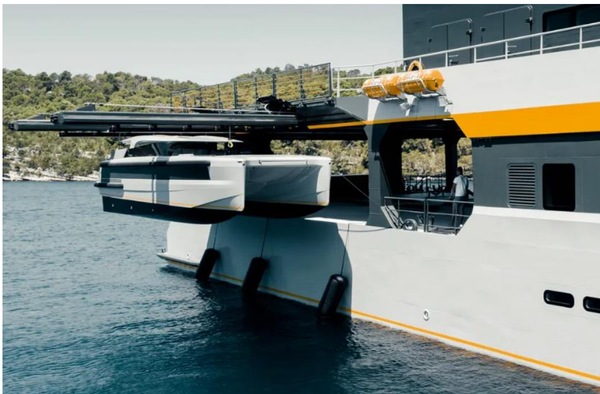
Figura 9. Grúa de izado lateral de embarcación tender del MY Nebula. Fuente: Boat international.
