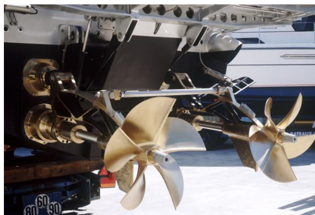
Figura 46. Hélices de superficie. Fuente: Surface Drive System.
