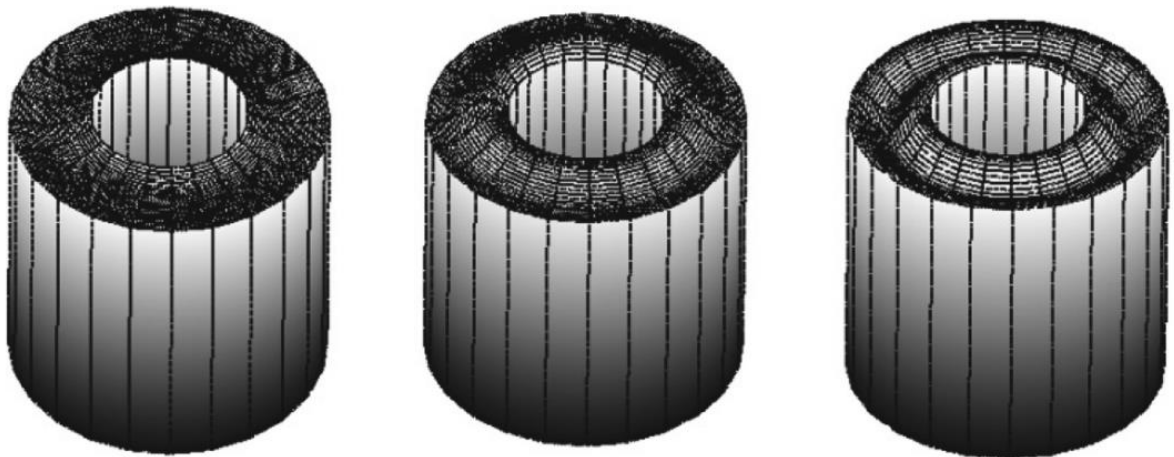
Рис. 5.5 Аксіально-симетричні форми коливань рідини в коаксіальних циліндричних оболонках.
