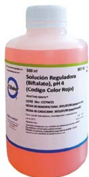
Solución de calibración para pH donde su valor conocido es de 4.00
