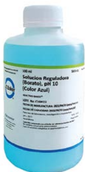
Solución de calibración para pH donde su valor conocido es de 10.00
