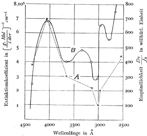
Abb. 2. Spektrale Empfindlichkeitskurve (A) der dünnen Schicht und Extinktionskurve (B) der 1-2-4-Diazonaphtolsulfosäure. Als Abszissenskala ist die Wellenlänge aufgetragen. Die rechte Ordinate gehört zur Empfindlichkeitskurve und gibt  $\frac{Dv}{J_0}$  in willkürlicher Einheit. Die linke Ordinate gehört zur Extinktionskurve und gibt  $\epsilon$  in  $\left[\frac{\text{g. Mol}}{\text{Liter}}\right]^{-1} \text{cm}^{-1}$  an. Der Extinktionskoeffizient wurde für die Wasserlösung gemessen.
