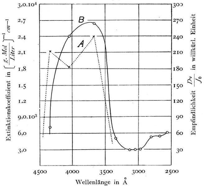
Abb. 4. Spektrale Empfindlichkeitskurve (A) der dünnen Schicht und Extinktionskurve (B) des p-Diazodiphenylaminsulfats.
