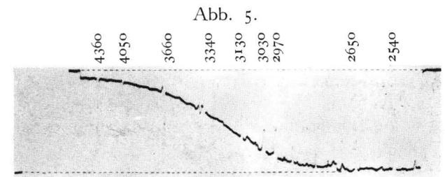
Abb. 5. Photometerkurve des Spektrums der Quarzwolframlampe.
