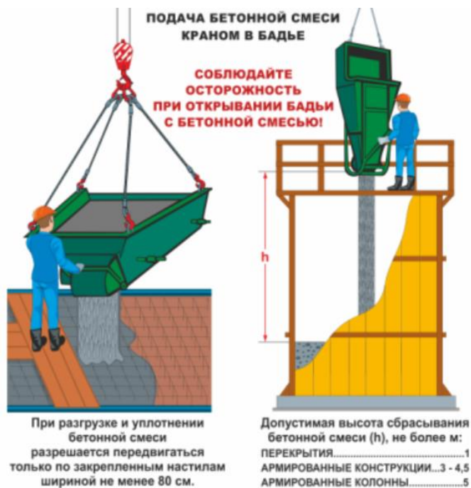
Рисунок 5.1 – Правила укладки бетона
