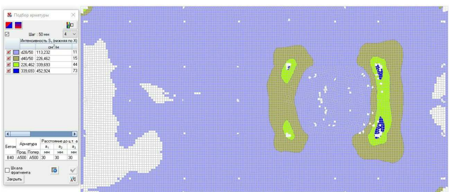
Изополя дополнительного верхнего и нижнего армирования фундаментной плиты по направлению OY (BK SCAD++) нижняя верхняя
