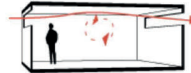
Gráfico 212 ventilación transversal. Fuente: Yusoproyectos, ventilación natural, 2013
