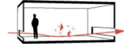
Gráfico 212 ventilación transversal. Fuente: Yusoproyectos, ventilación natural, 2013
