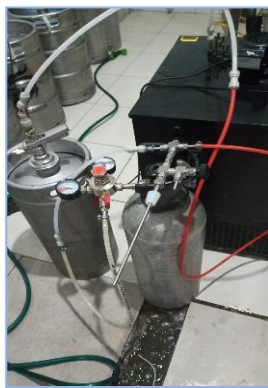
Figura 42. Equipos para carbonatación, barriles de acero inoxidable, tanque de CO 2 y llenador de botella.
