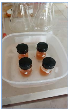
Figura 55. Enfriamiento de muestras para medir la Turbiedad.
