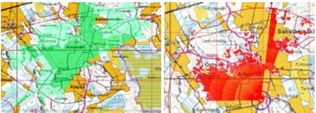
Kuva: Esimerkki näkemäalueanalyysistä. Vasemmalla Terrabase II toteutettuna pelkällä korkeusmallilla ja oikealla kenttätykistön johtamislaitteen näkemäviivasarja laskettuna maastomallista. [Nen02]
