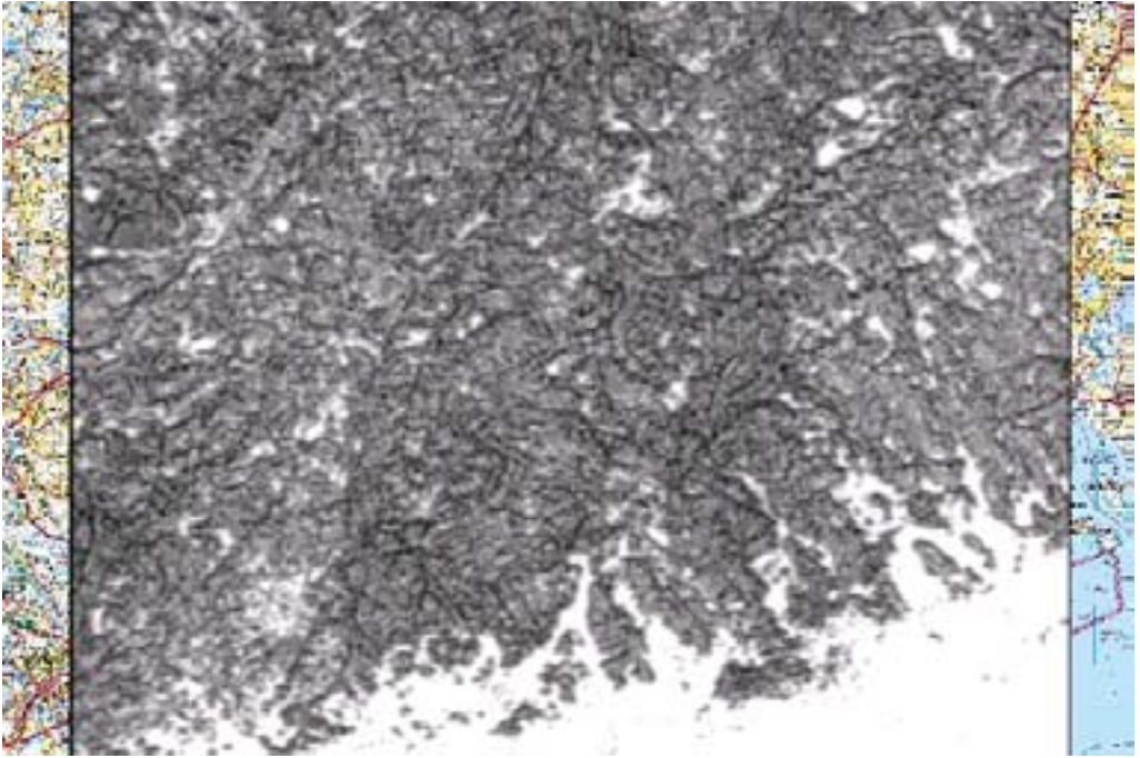
Kuva: Yleistetty 3 asteen ilmakatvealuekartta, tarkastelu suunta 360 astetta ja alueen leveys 100 km. Kuvaa voi käyttää esimerkiksi vastustajan taisteluhelikopterien välttämiseen: jos kone on esimerkiksi 100 m korkeudella, tummin alue antaa katveen yli 2 km päästä riippumatta sijainnista maalin suhteen.
