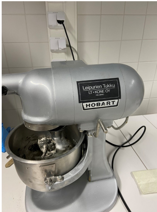
Figur 13. Hobart N-50 stativblandare används för att blanda bindemedlen i lerproven.
