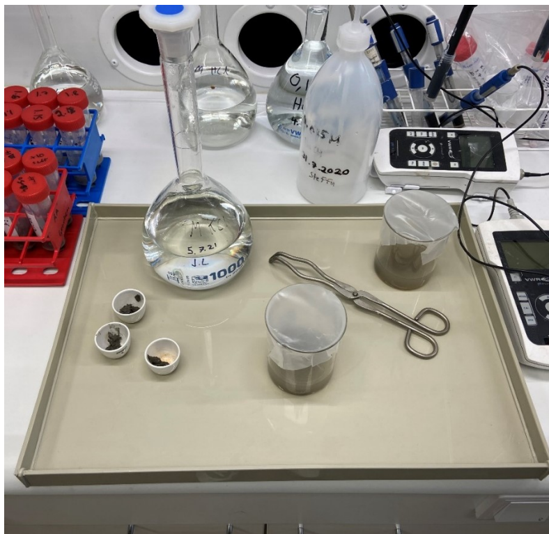
Figur 10. Lerprov och kaliumkloridlösning placeras i dekanterglas inför aciditetsuppmätningen.
