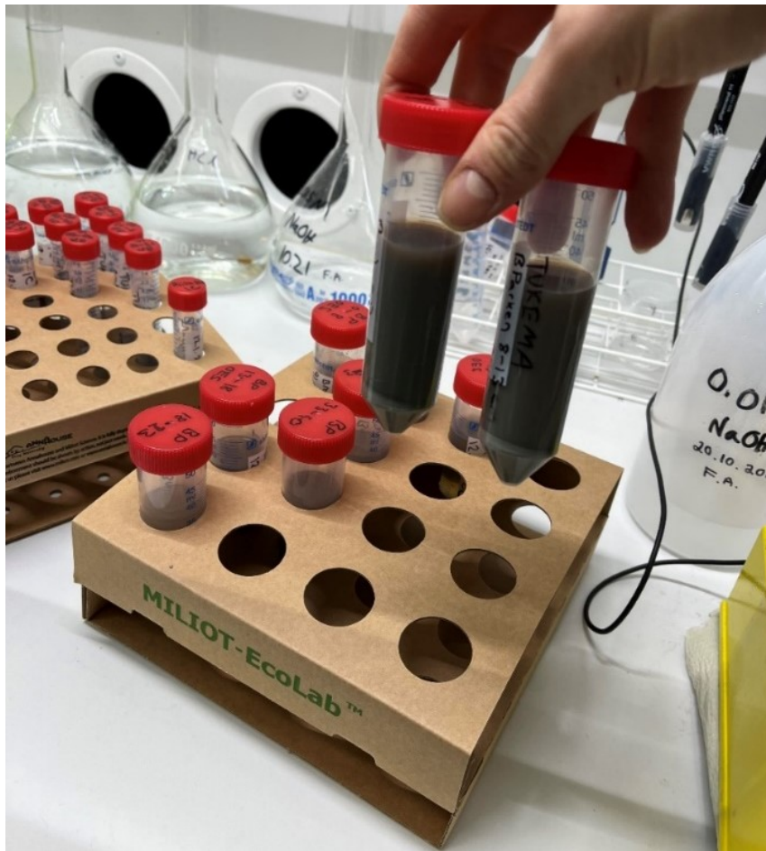
Figur 19. I några prov är leran fortsättningsvis i suspension efter 10–15 minuters centrifugering med 3600 varv/min. Detta tyder på att det måste handla om ytterst finkorniga lerjordar.
