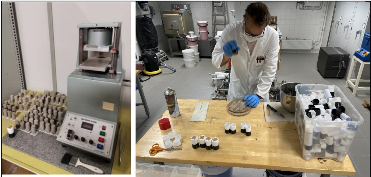
Figur 14. Bindemedelskombinationerna placerades i vita provkoppar för 7, 28 och 91 dagar. I vänstra bilden står provcylindrarna uttagna från provkopparna som provtrycktes under pressen (vänster bild från Jarva et al. 2021)
