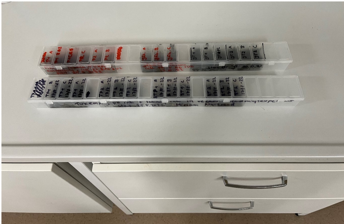
Figur 9. Lerproven placerades i chipbrickor för 19 veckors inkubation.
