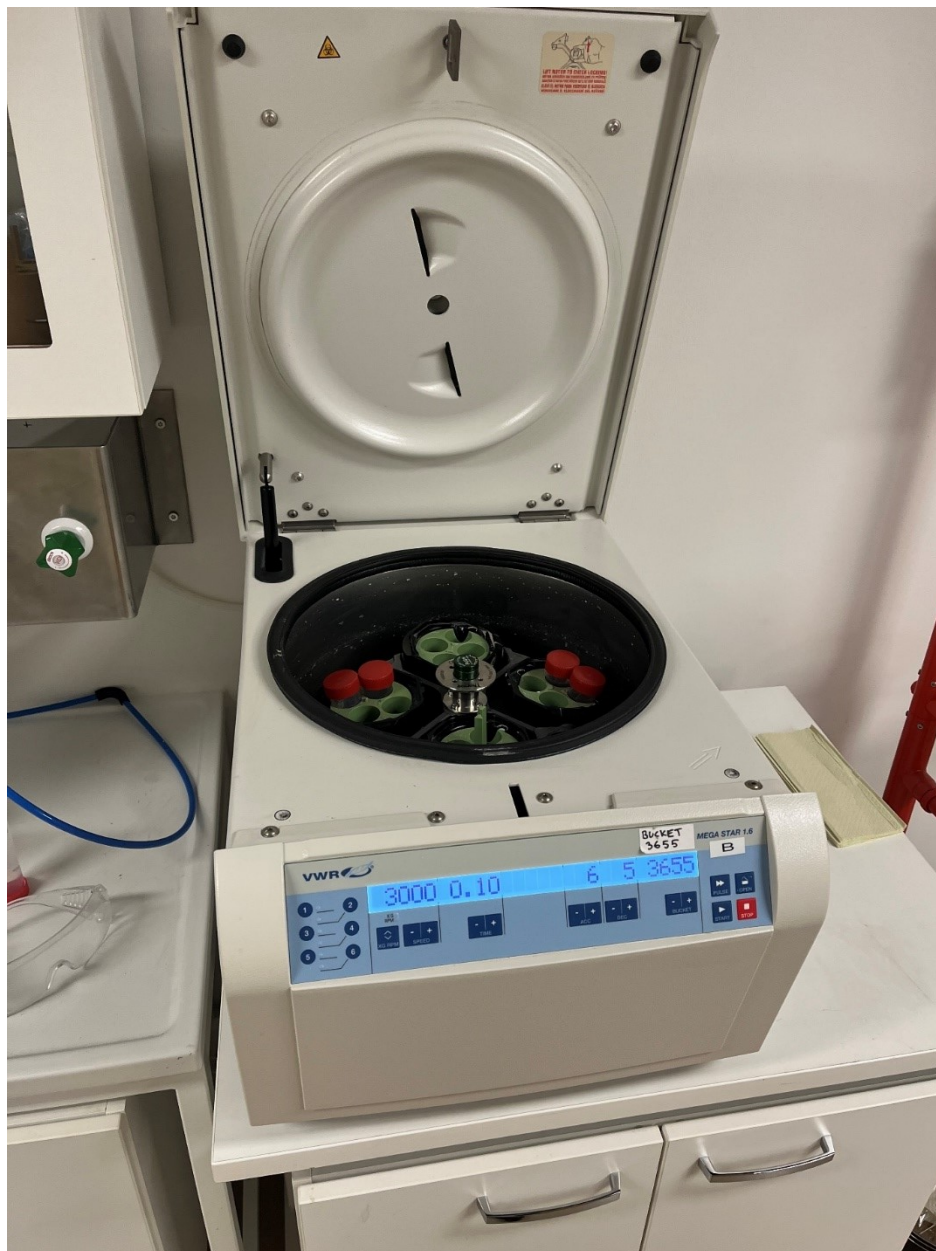
Figur 15. Lakvattenproven centrifugerades i 10 minuter för att underlätta filtreringen av lakvattenproven.
