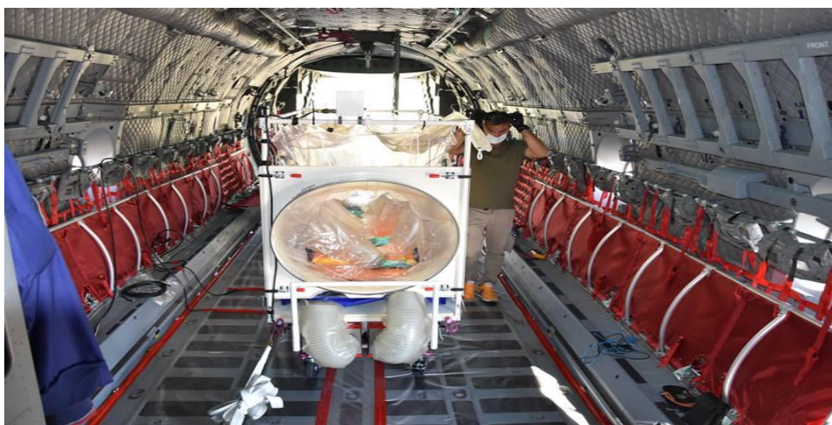
Fig. 4. Sistema di biocontenimento 'Aircraft Transit ISOLator' (A.T.ISOL) a bordo del C-27 J.
