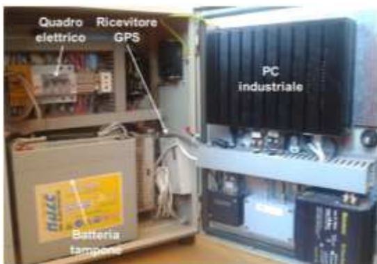
Figura 6.5 Sistema di controllo del GPS, utilizzato nel corso delle acquisizioni.
