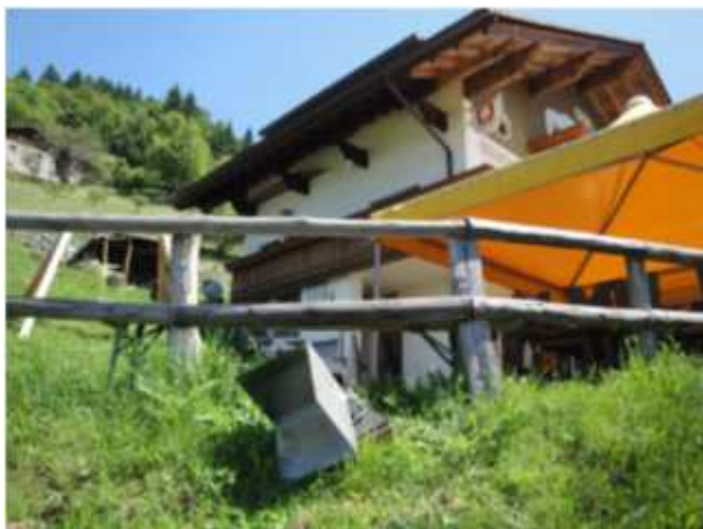
Figura 8.4 Particolare del corner reflector installato su un'area ritenuta stabile.
