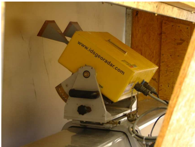
Figura 4.22 Dettaglio delle antenne del radar, si osserva la loro forma a tromba.
