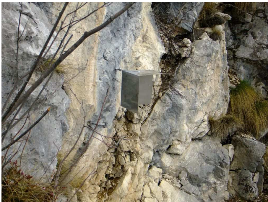
Figura 6.7 Corner reflector posizionato in parete sul Crep di Savath
