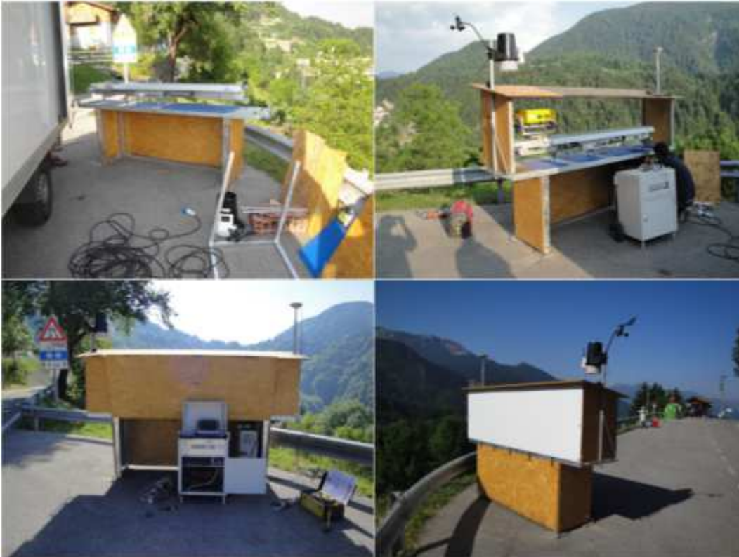
Figura 6.1 Postazione di misura GBSAR, completa di tutte le sue componenti.
