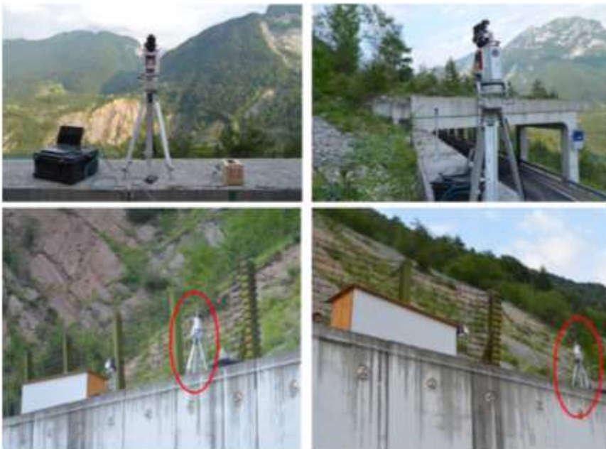
Figura 8.76 Vista della strumentazione laser scanner sulla postazione di misura.
