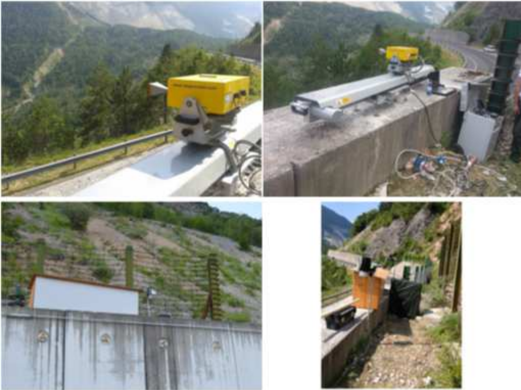
Figura 8.46 Particolare dell'installazione della piattaforma GBSAR.
