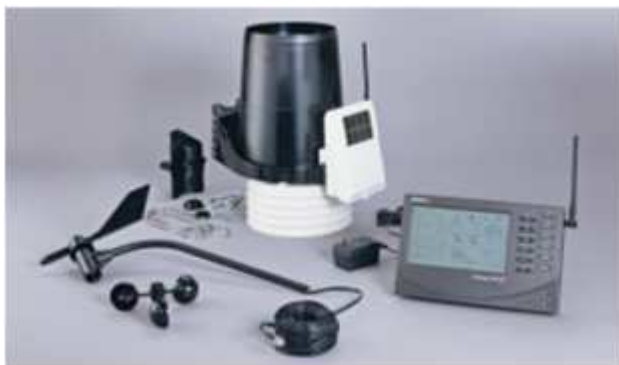
Figura 6.6 Dettaglio dei componenti la stazione meteo utilizzata durante le acquisizioni.
