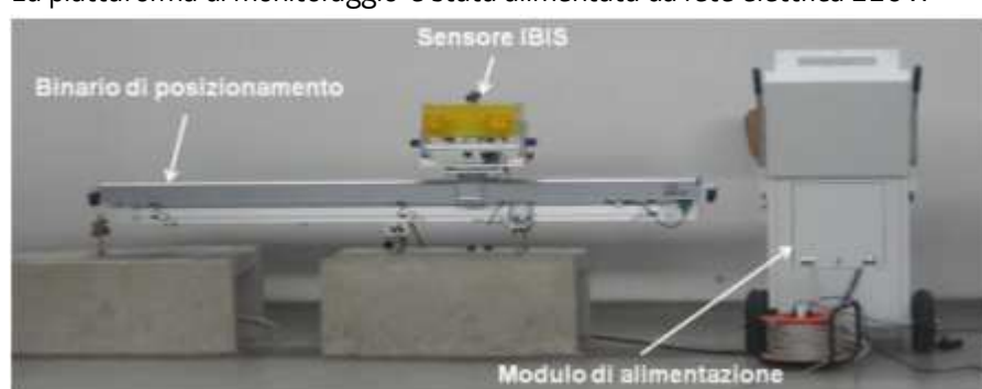
Figura 6.3 Sistema a moduli della piattaforma di monitoraggio GBSAR IBIS-L, analoga a quella utilizzata nelle misure
