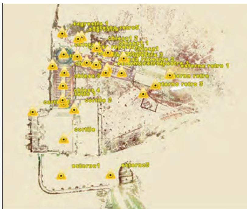
Fig. 2 – Posizione geospaziale dei punti di presa (ScanStation) necessari a coprire l'oggetto del rilievo. Il rilievo con tale tecnologia ha permesso di ottenere pianta e prospetto (Fig. 3) della Chiesa.
