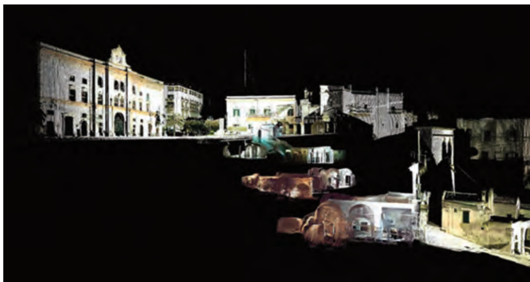
Fig. 12 – Nuvola di punti con caratteristiche cromatiche (RGB): vista di Piazza Vittorio Veneto e degli Ipogei.
