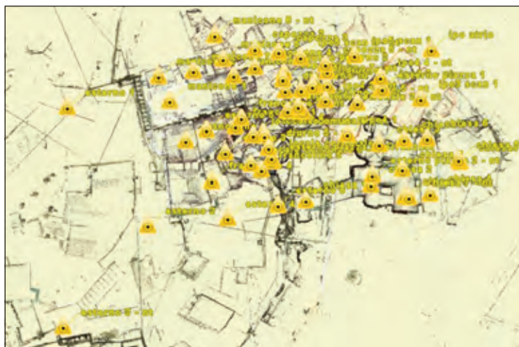
Fig. 11 – Posizione geospaziale dei punti di presa (ScanStation) necessari a coprire l'oggetto del rilievo.
