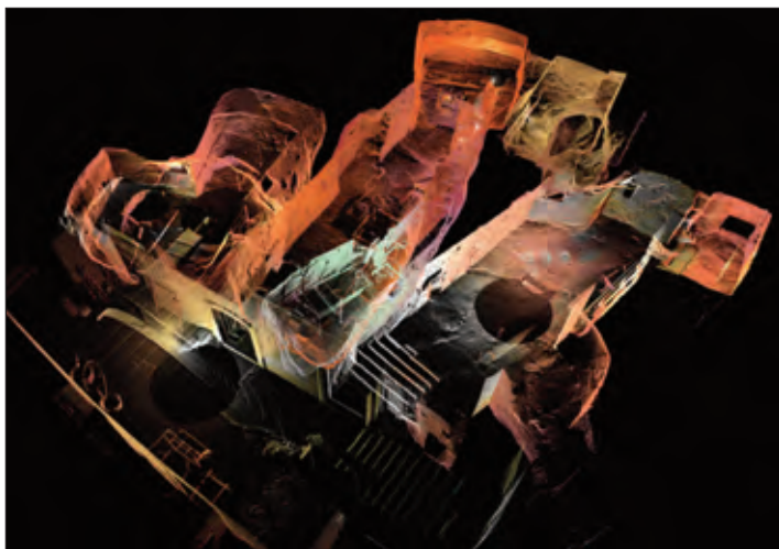
Fig. 13 – Nuvola di punti in visualizzazione modalità Silhouette (RGB): vista parte Ipogei.
