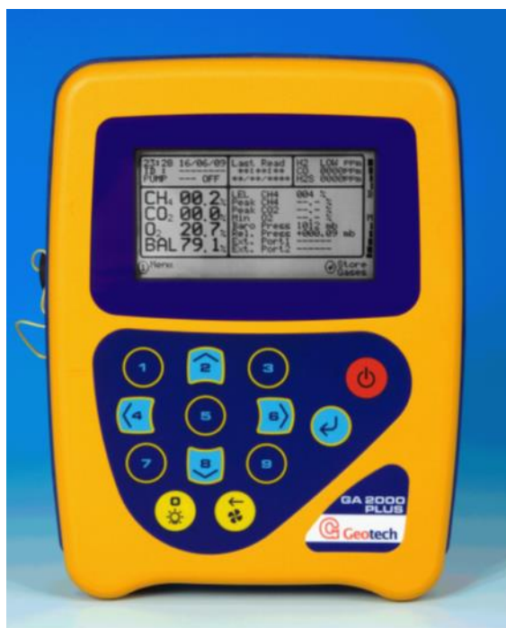
Figura 5: Foto dell'analizzatore di biogas in dotazione in laboratorio
