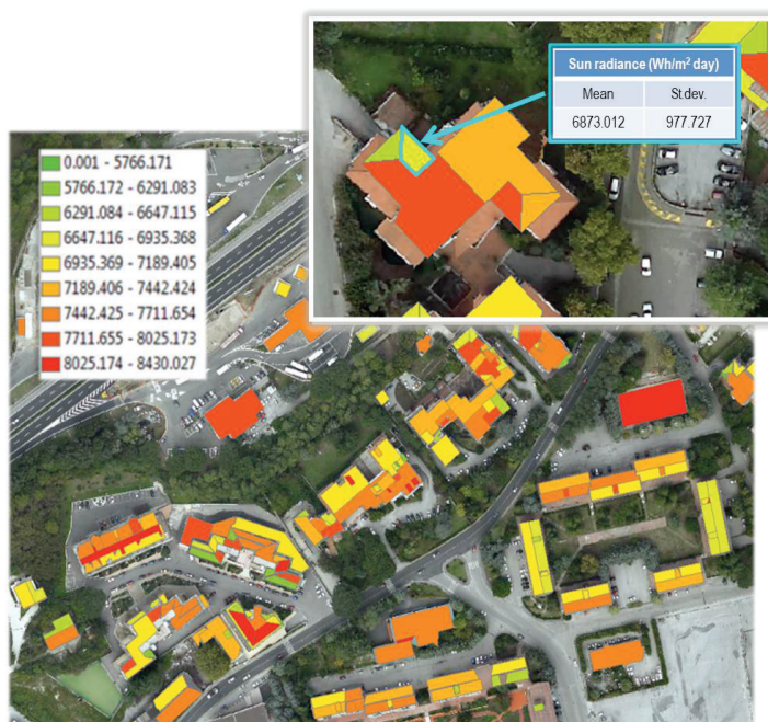
Fig. 10 – Mappa dettagliata riportante il valore cumulato di radianza solare specifica per un giorno di luglio (valori in Wh/m^2 \cdot day ) per ogni tetto estratto dal DSM e caratterizzato in ambiente GIS.
