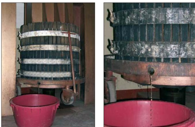
Fig. 4 a; 4 b – Torchio e particolare della torchiatura
