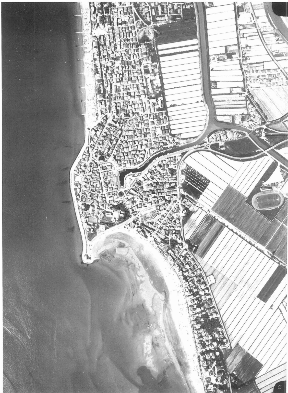
Fig. 6 - L'antico nucleo urbano di Caorle difeso dal mare da una scogliera. Si notino antiche opere di difesa inghiottite dal mare nei fondali antistanti l'attuale murazzo. A destra risaltano i bassi fondali insabbiati (cfr. fig. 5) a sinistra la spiaggia di ponente di Caorle difesa da una serie di pennelli.
