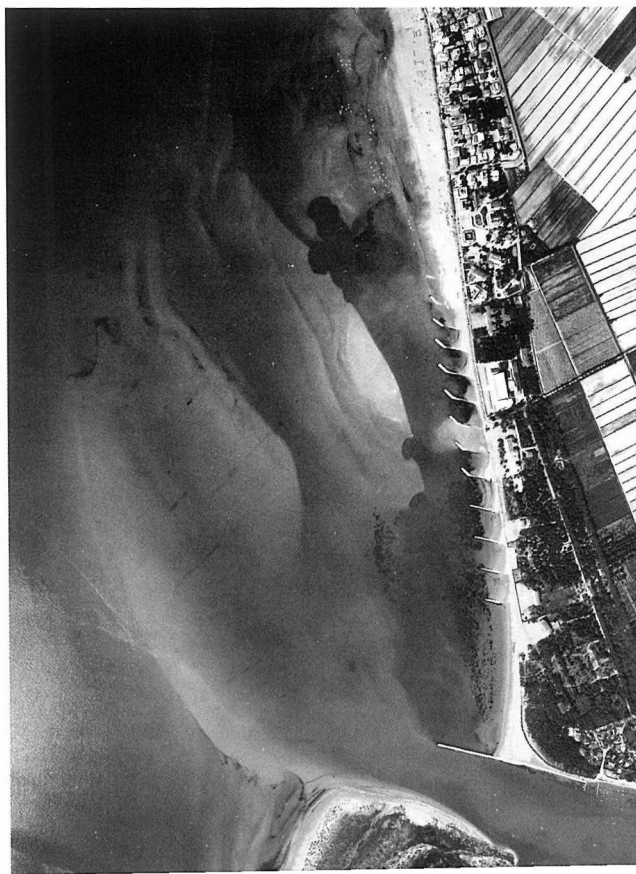
Fig. 5 - Il Porto di Falconera e la spiaggia di levante di Caorle. La diversione verso Ovest delle sabbie lungo la spiaggia di Valle Vecchia, nonostante l'intervento in destra della foce (pennello) ha dato origine al forte insabbiamento dei fondali antistanti la zona balneare con compromissione e decadimento degli stessi per il ristagno d'acqua e la conseguente presenza di fanghi (cfr. figg. 4 e 6).
