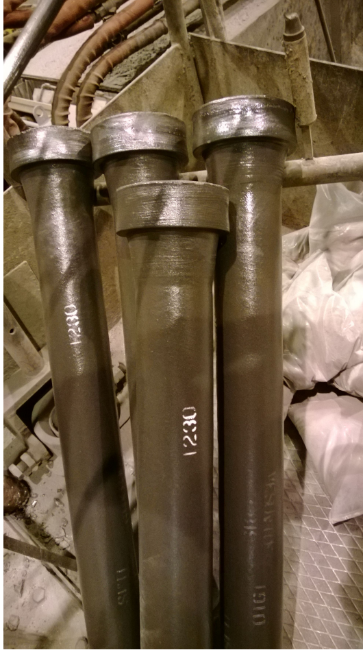
FIGURA 1.10: Tuffanti per protezione contro l'ossidazione dell'acciaio.
