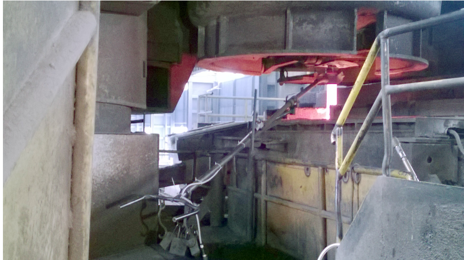
FIGURA 1.11: Tipico braccio porta tuffante, con contrappesi.
