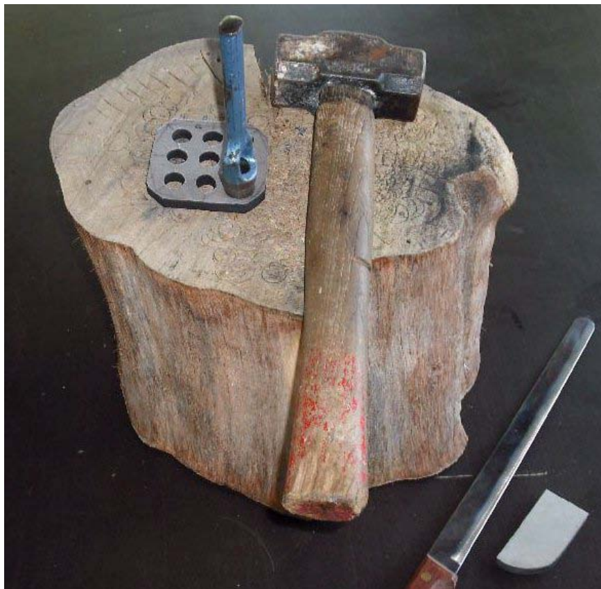
Figura 4 (esecuzione dei fori)
