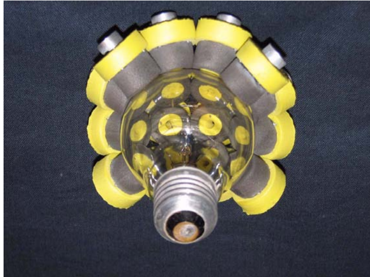
Sequenza 10 (esempio di malleabilità e aderenza della cuffia deformabile)
