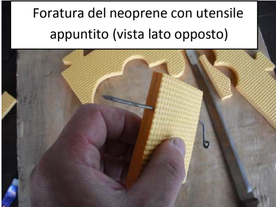
Foratura per l'inserimento del terzo filo perpendicolare agli altri due
