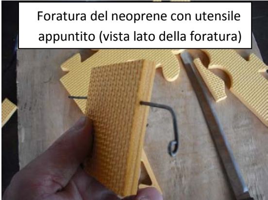
Foratura per l'inserimento del secondo filo metallico
