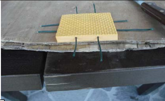
Inserimento dei 4 fili metallici che costituiscono l'"anima" del probe (vista laterale)
