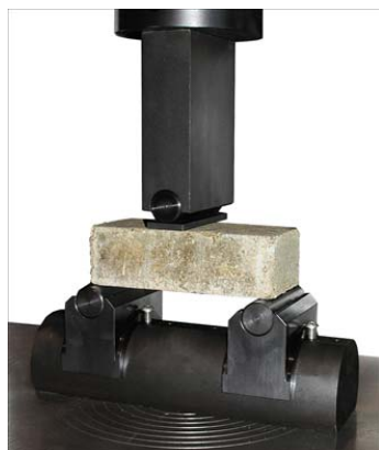
FIGURA 18: PROVE A FLESSIONE E COMPRESSIONE SU MATTONI
