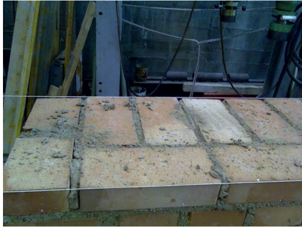
FIGURA 3: TESSITURA DEI PROVINI VISIBILE DURANTE LE FASI DI COSTRUZIONE NEL PIANO DELLA SEZIONE
