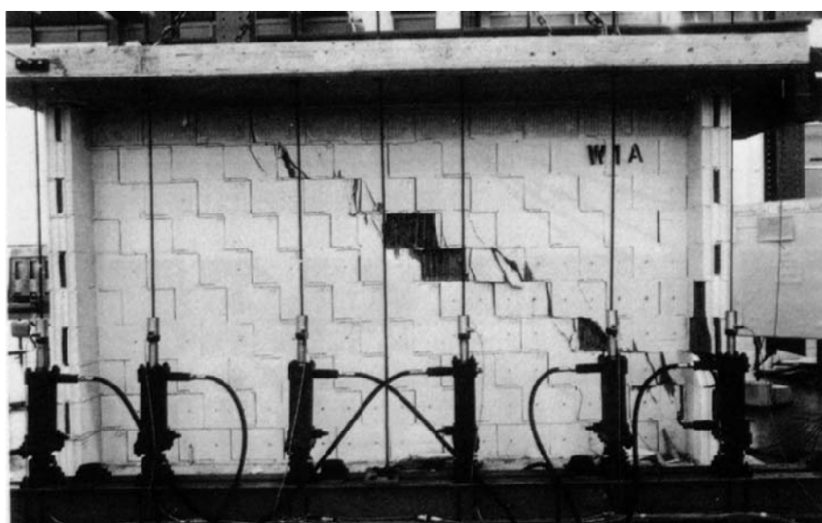
FIGURA 8: ESITO DELLA PROVA DI TAGLIO SUL PANNELLO W1
