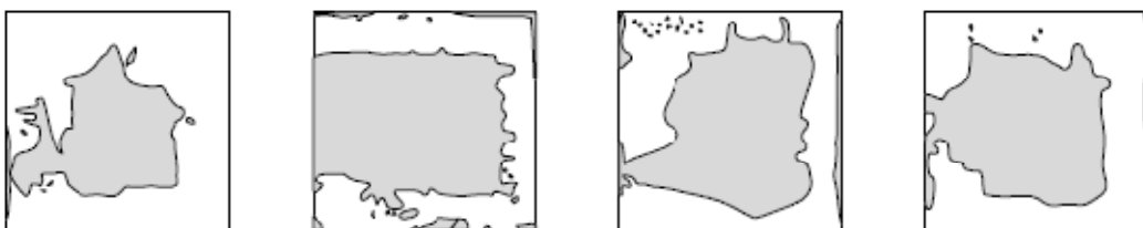
FIGURA 5: LA SUPERFICIE DI CONTATTO NETTA UNITÀ-MALTA DI VARI MURETTI
