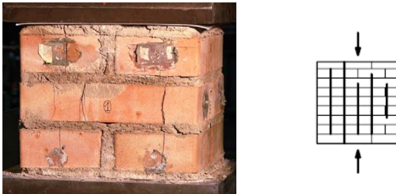
FIGURA 24: FESSURAZIONI VERTICALI NEI BLOCCHI DOPO UNA PROVA A COMPRESSIONE MONOASSIALE
