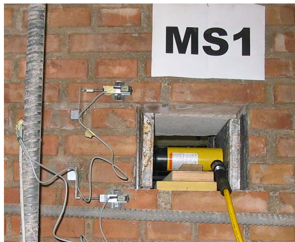
FIGURA 51: L'APPARATO DELLA PROVA A TAGLIO SUL PROVINO RIMANEGGIATO
