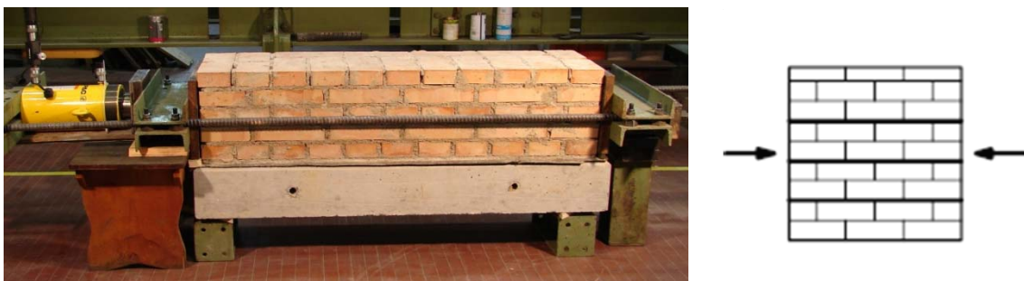
FIGURA 25: ROTTURA A COMPRESSIONE PARALLELA AI GIUNTI ORIZZONTALI
