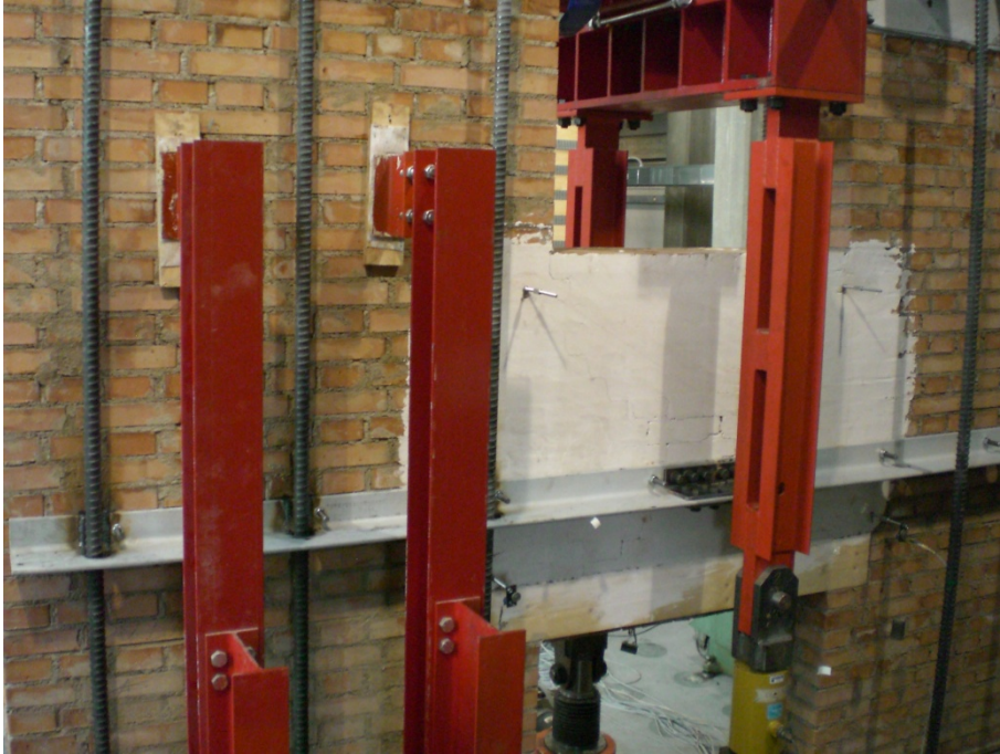
FIGURA 41: IL RINFORZO MEDIANTE PROFILO AD "L"
