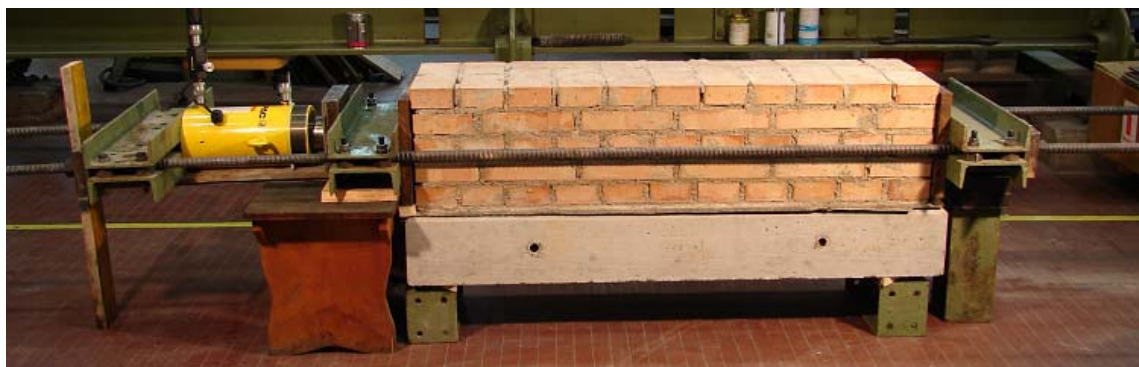
FIGURA 49: L'APPARECCHIATURA DELLA PROVA A COMPRESSIONE ORIZZONTALE
