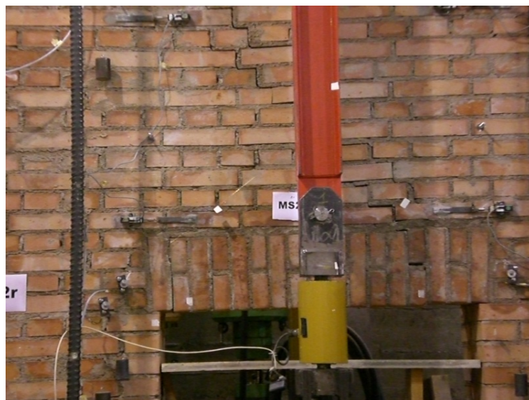
FIGURA 45: ESEMPI DELLO STATO FESSURATIVO SVILUPPATOSI NEL CORSO DELLA PROVA
