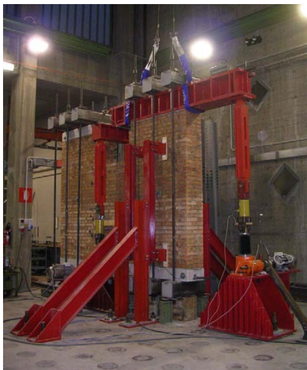
FIGURA 16: IL PRIMO PROVINO AL MOMENTO D'INIZIO DELLA PROVA MS1
