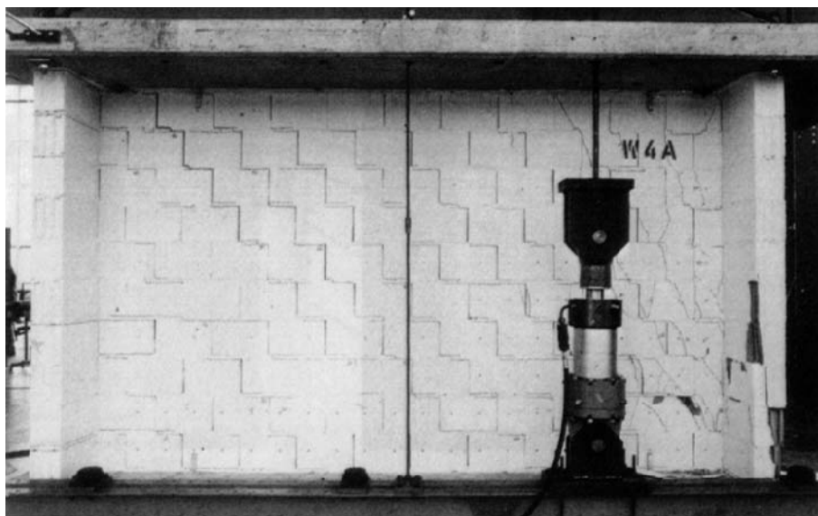
FIGURA 12: ESITO DELLA PROVA DI TAGLIO SUL PANNELLO W4
