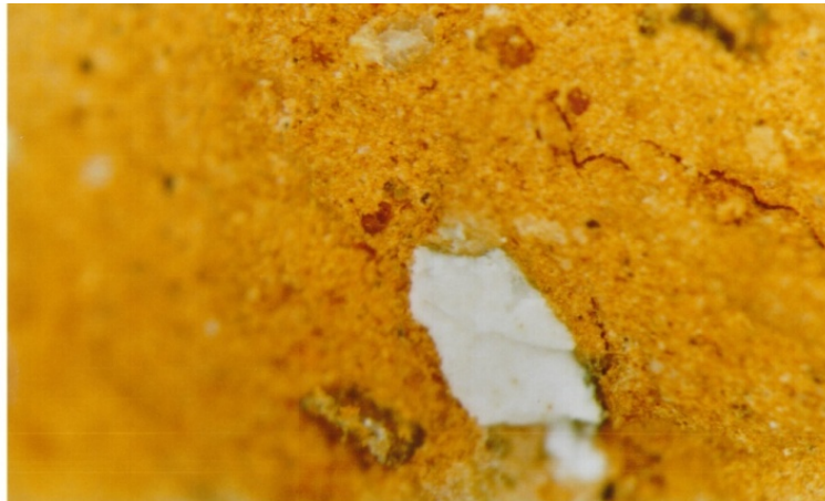
FIGURA 21: ANALISI AL MICROSCOPIO STEREOSCOPICO DEL LATERIZIO ROSSO
