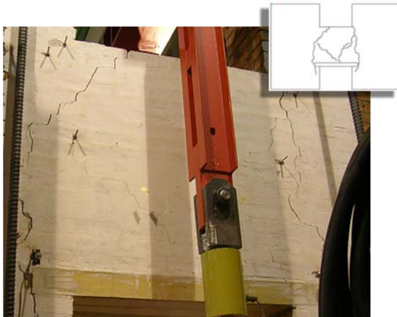
FIGURA 23: SVILUPPO DELLE FESSURE VERTICALI (CICLO N.10)
