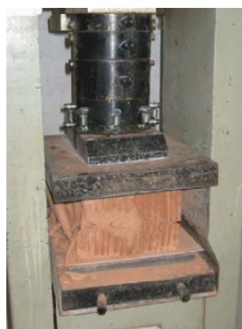
FIGURA 18: PROVE A FLESSIONE E COMPRESSIONE SU MATTONI
