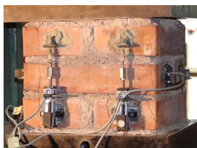
FIGURA 19: PROVE A COMPRESSIONE E TAGLIO SU MURETTI
