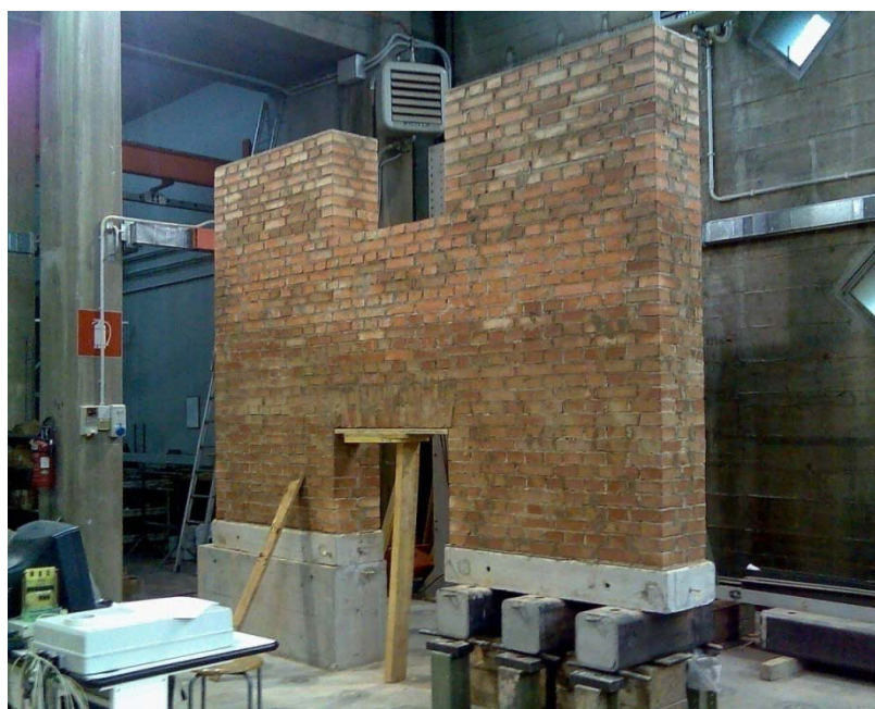
FIGURA 20: IL PROVINO MS3 AL TERMINE DELLA COSTRUZIONE
