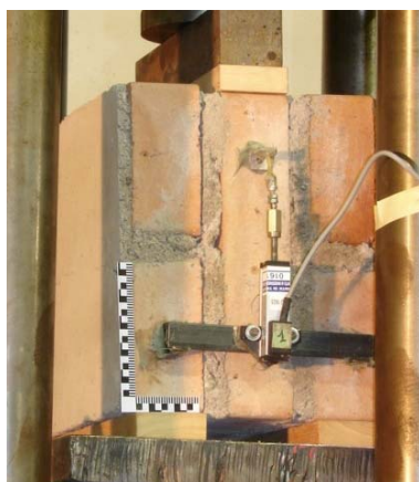
FIGURA 29: PROVA A TAGLIO SU MURETTO
