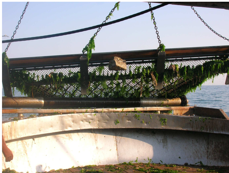
Figura 38. a) Configurazione del rapido e modalità di traino; b) Salpamento del rapido.
