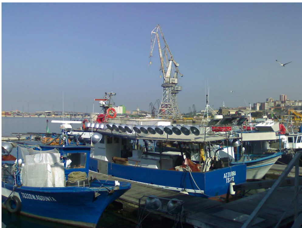
Figura 23. Tipica imbarcazione moderna (lampara) per la pesca con la saccaleva nel Golfo di Trieste.
