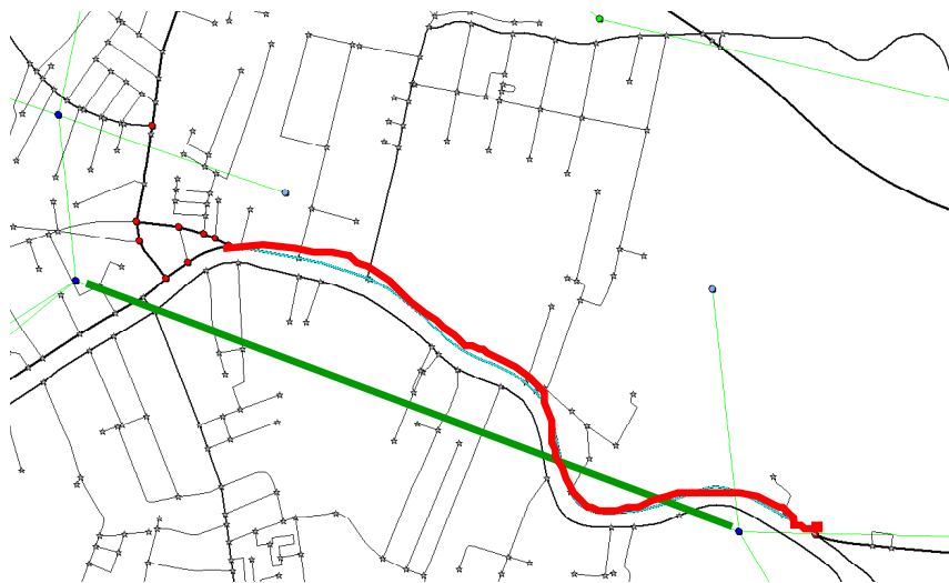
Figura 4-3 - Esempio di utilizzo della procedura Map Basic per l'identificazione degli elementi di corrispondenza tra le reti di livello 1 e 2. Passo 2: visualizzazione degli elementi corrispondenti.
