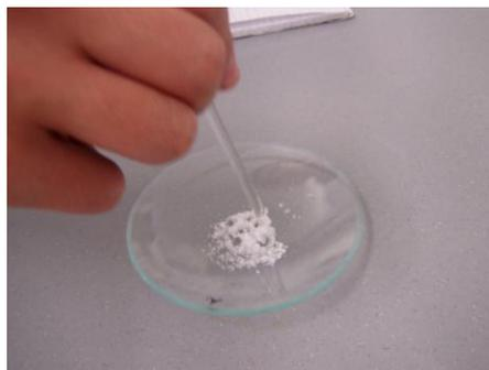
Figura 7. In seguito a un urto, un pezzo di canfora si rompe ma non va in pezzi, essa non è né fragile né malleabile (Foto: P. Dall'Antonia).
