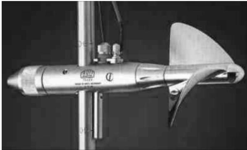
Fig. 9.2 – Mulinello idrometrico.
