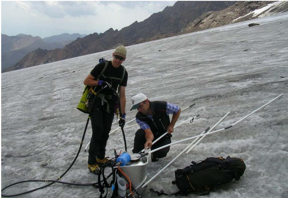
Fig. 9.5 – Fase di perforazione con la trivella a vapore Heucke.
