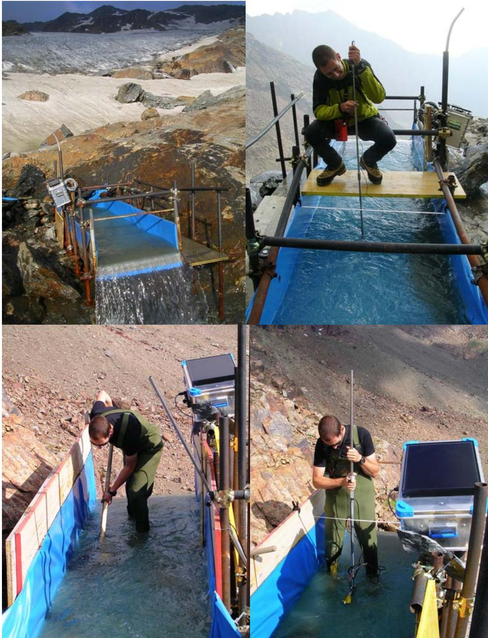
Fig. 9.8 – La stazione idrometrica in orografica sinistra e relativa misura di portata (in alto); rimozione dei detriti e misura di portata nella stazione idrografica in orografica destra (24 agosto 2007).
