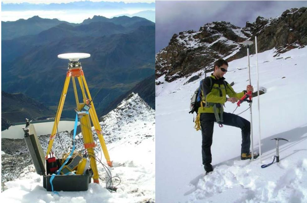
Fig. 9.7 – Il *reference* a sinistra e *rover* a destra.
