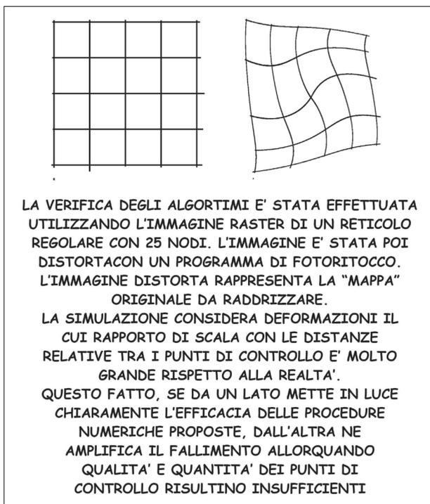
Fig. 4. Efficacia degli algoritmi del processo numerico di raddrizzamento delle mappe catastali informatizzate.
