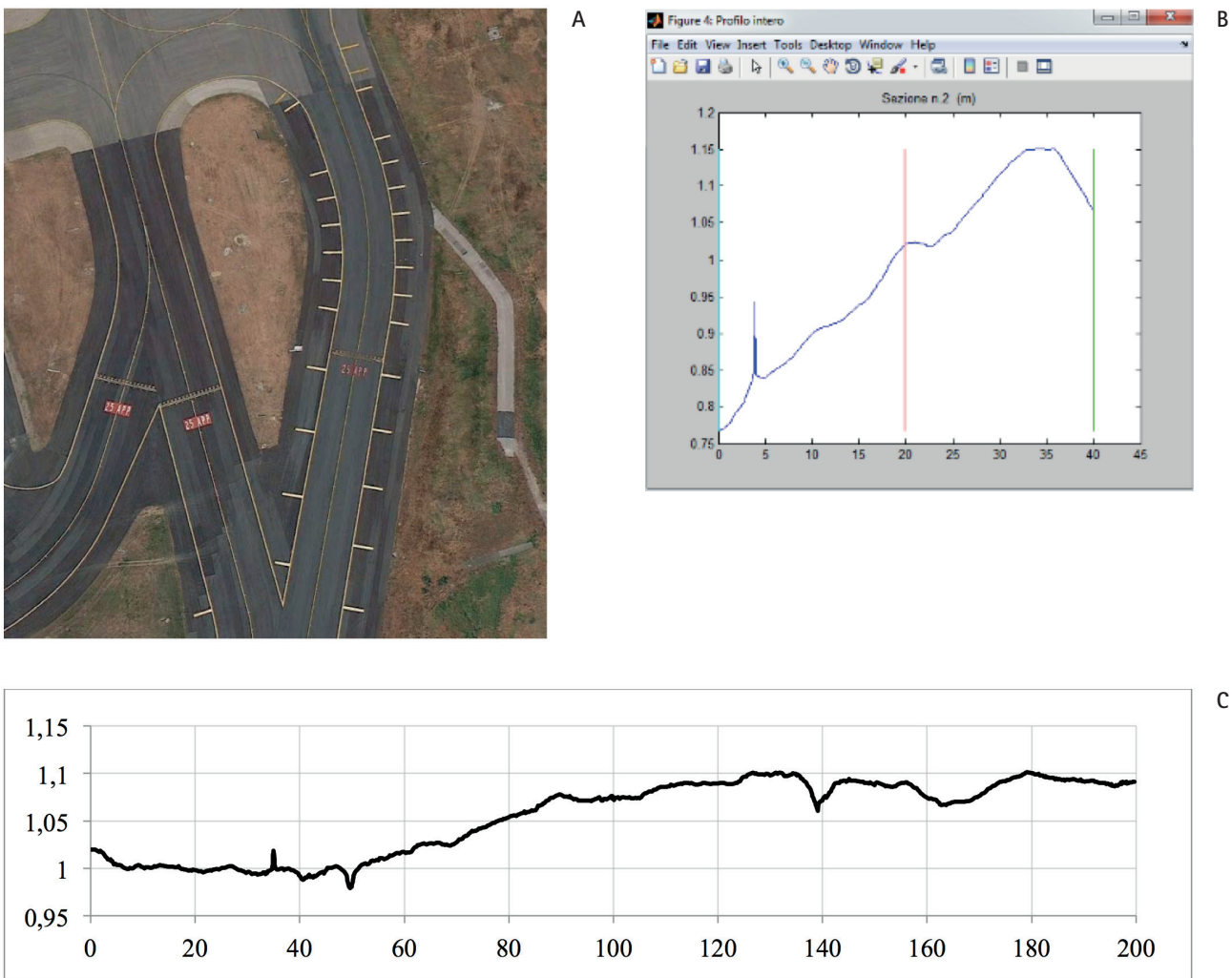
FIGURA 7 – Tratto di pista aeroportuale e profili trasversali e longitudinali rilevati con laser scanner
