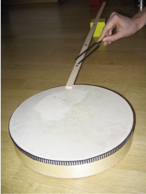
Figura A.2 Diapason e tamburo; la vibrazione passa lungo la bacchetta e si trasmette alla membrana del tamburello .
