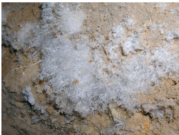
Fig. 8 Mineralizzazioni secondarie del tufo (foto degli autori) Fig. 8 Tuff secondary mineralizations (photo by the authors)
