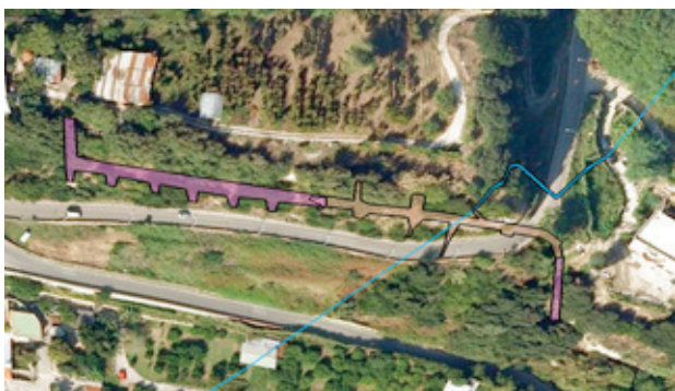
Fig. 9 Visione in pianta dell'area di Scalandrone e, sovrapposta, la pianta della cavità nota (in ocra), delle sue parti ancora da esplorare (in viola) e dell'acquedotto (in azzurro) (da Google Earth, modificato, Nord a destra)
