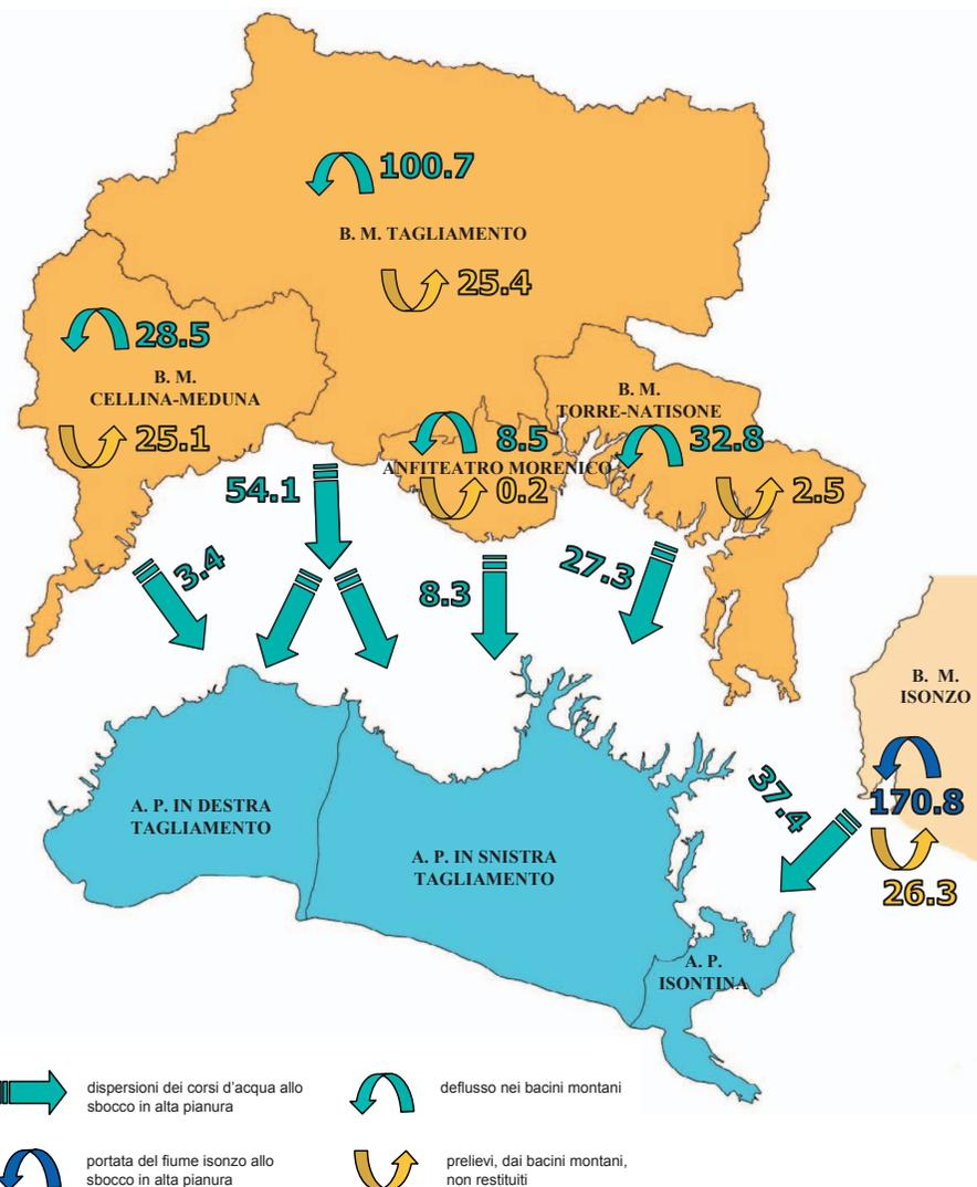
Entità delle risorse montane e di quelle che vanno ad alimentare l'Alta Pianura Friulana. A fronte delle notevoli potenzialità della montagna derivate dalle precipitazioni, si contrappongono gli intensi prelievi, essenzialmente per uso idroelettrico ed irriguo.
