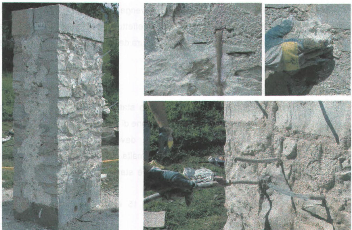
Fig. 71: Iniezione su modelli in pietra a tre paramenti.
