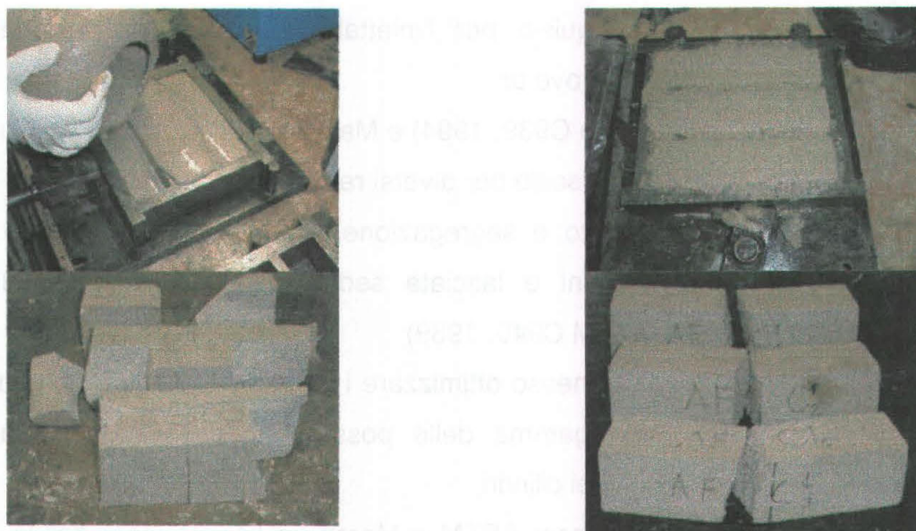
Fig. 47: Preparazione dei campioni di miscela (sx) e malta (dx) per le prove meccaniche. Si nota come per le miscele sia stato impossibile effettuare i test (realizzati invece senza problemi per le malte), a causa del danneggiamento provocato dal ritiro.
