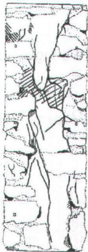
Fig. 30: Quadro fessurativo e diagramma sforzi-deformazioni tipici (Pisano, 1999).
