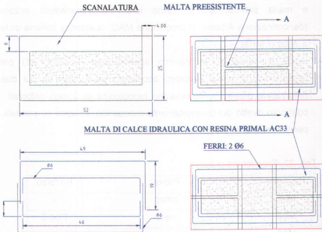
Fig. 132: Intervento di consolidamento per prove di creep: rinforzo Tipo 1 (pannelli M04 e M06).
