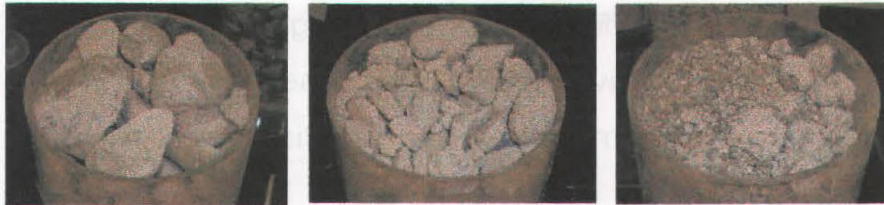
Fig. 57: Riempimento dei cilindri a granulometria singola.
