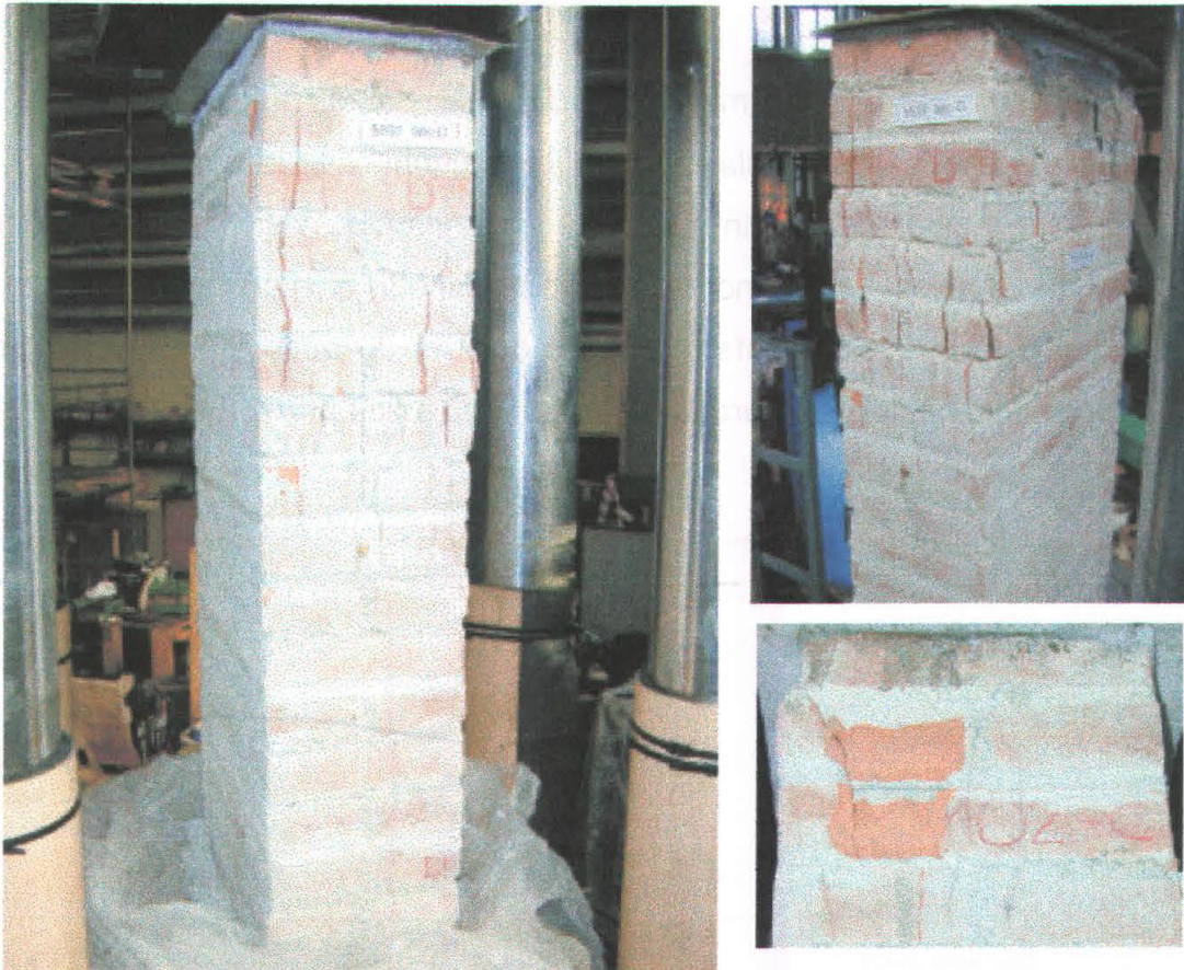
Fig. 136: Fessurazione rilevata su un muro rinforzato dopo la prova di creep (M02).
