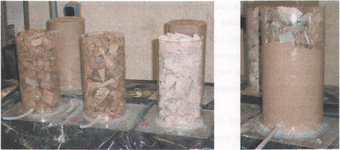
Fig. 56: Cilindri saturi e anidro prima dell'iniezione e fase di riempimento (scaglie muro).
