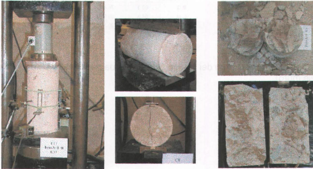
Fig. 63: Prove meccaniche ed ispezioni sui cilindri.
