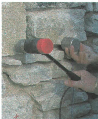
Fig. 84: Esecuzione di prove soniche e prove von i martinetti piatti doppi
