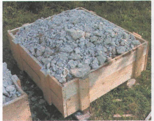
Fig. 55: Realizzazione e frantumazione dei riempimenti per i cilindri (scaglie muro).
