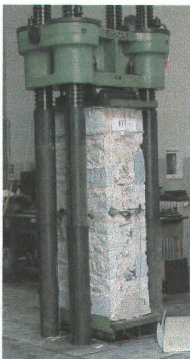
Fig. 75: Apparecchiatura di prova e posizionamento dei trasduttori di spostamento.
