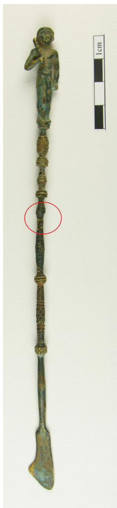
FIGURA 3.1 Strumento nr. 1: scalpello/bisturi pseudo-antico dalla collezione Rossi. Particolare delle saldature sull'asta (foto Sara Emanuele, Soprintendenza Archeologia del Veneto)
