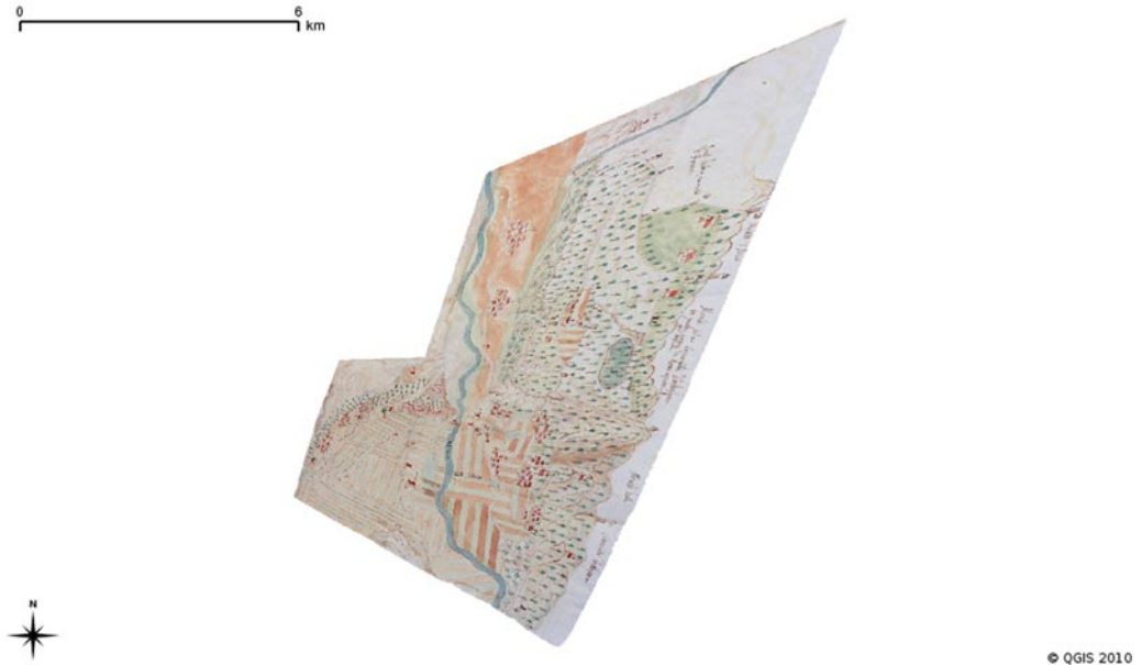
Fig. 4 - La deformazione del cabreo di Arco attuata dal software di rettificazione utilizzato per il tentativo di georeferenziazione.
