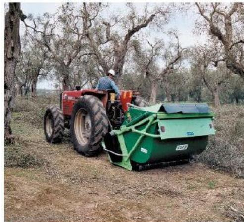
Figura n.75: macchina trinciatrice all'opera in un uliveto
