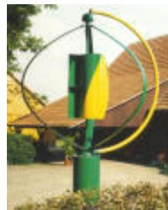
Figura n.60: L'eolico ad asse verticale
