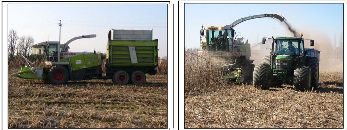
Figura n.74: Macchina falcia-trincia - caricatrice e macchina all'opera durante la raccolta di kenaf
