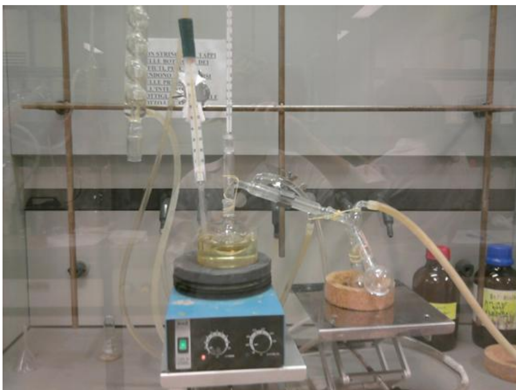
Figura 2. Apparecchio di distillazione utilizzato durante il Laboratorio di Chimica organica (Fonte: foto tratte dalle relazioni di laboratorio presentate dai corsisti relative al modulo di Chimica organica).
