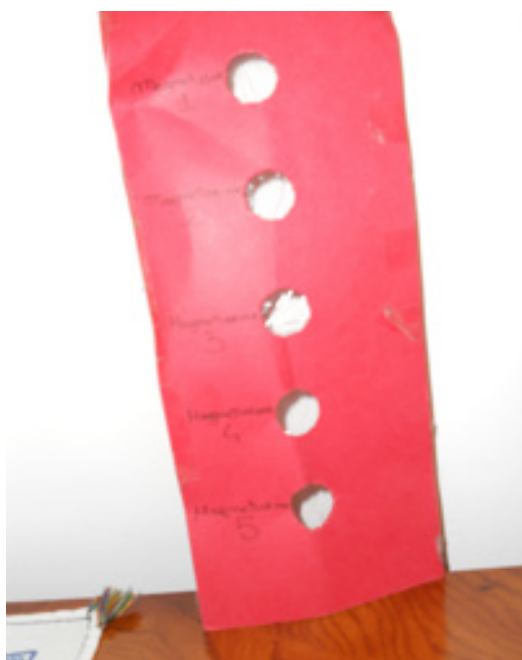
Figura 2. Il "calibro stellare" per la misura dell'intensità di una sorgente luminosa.
