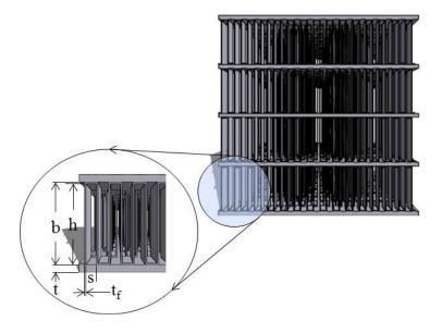
Figure 34: Diagram of fin parameters and geometry<sup>98</sup>
