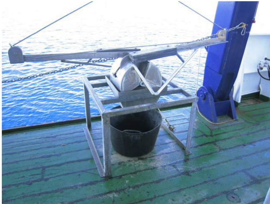
Figura 2A.4. Draga Van Veen utilizada para el muestreo de sedimento durante la campaña de investigación MAO1401_GEOBentos.
