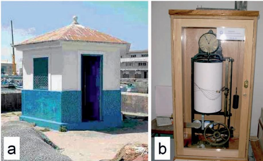
**Figura 3.1.** Ejemplo del equipamiento de las estaciones mareográficas: caseta de la estación de Vigo (a) y mareógrafo mecánico de flotador con codificador (b).
