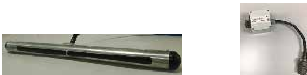
Figura 7. Detalle del transductor de barrido lateral (izquierda) y de la caja convertora entre tecnología split-beam y single-beam (derecha).
