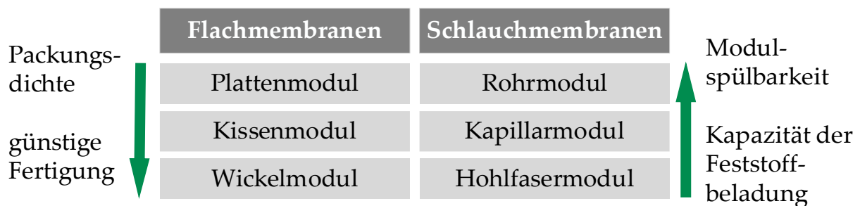
Abbildung 2-7: Übersicht der verfügbaren Bauformen von Membranmodulen (adaptiert nach [Melin 2007])
