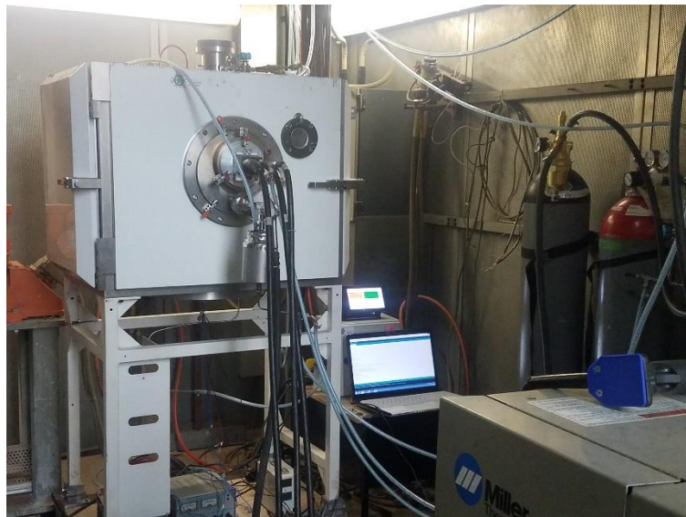
Abb.1: Konstruierte Prozesskammer zur Gewährleistung einer XHV-adäquaten Prozessumgebung mit angeflanschter Strahl- und Beschichtungseinheit.
