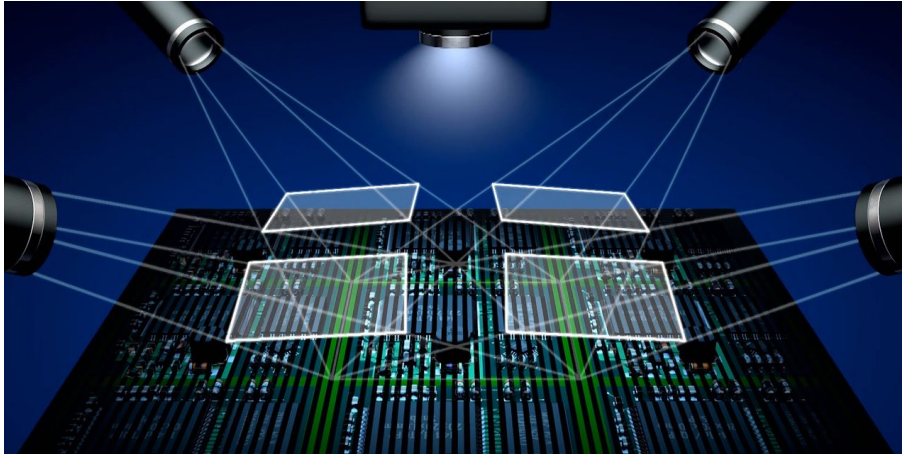
Abbildung 2.12.: Schema AOI-Streifenprojektion – vier geneigte und eine orthogonale Kamera [Vis22c]
